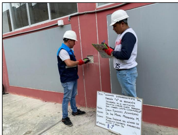
Figura 22. Ensayo de esclerometría en columna.
