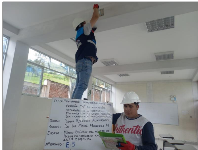
Figura 25. Ensayo de esclerometría en columna
