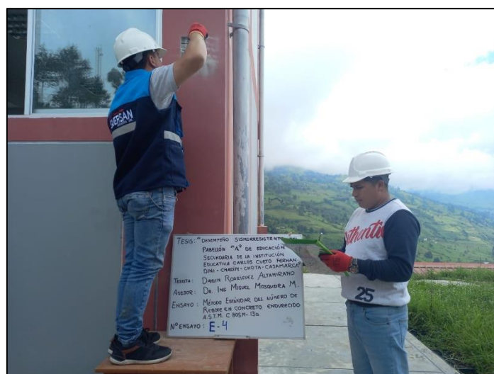
Figura 25. Ensayo de esclerometría en columna
