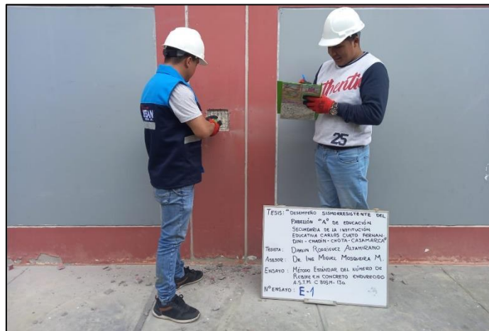
Figura 22. Ensayo de esclerometría en columna.
