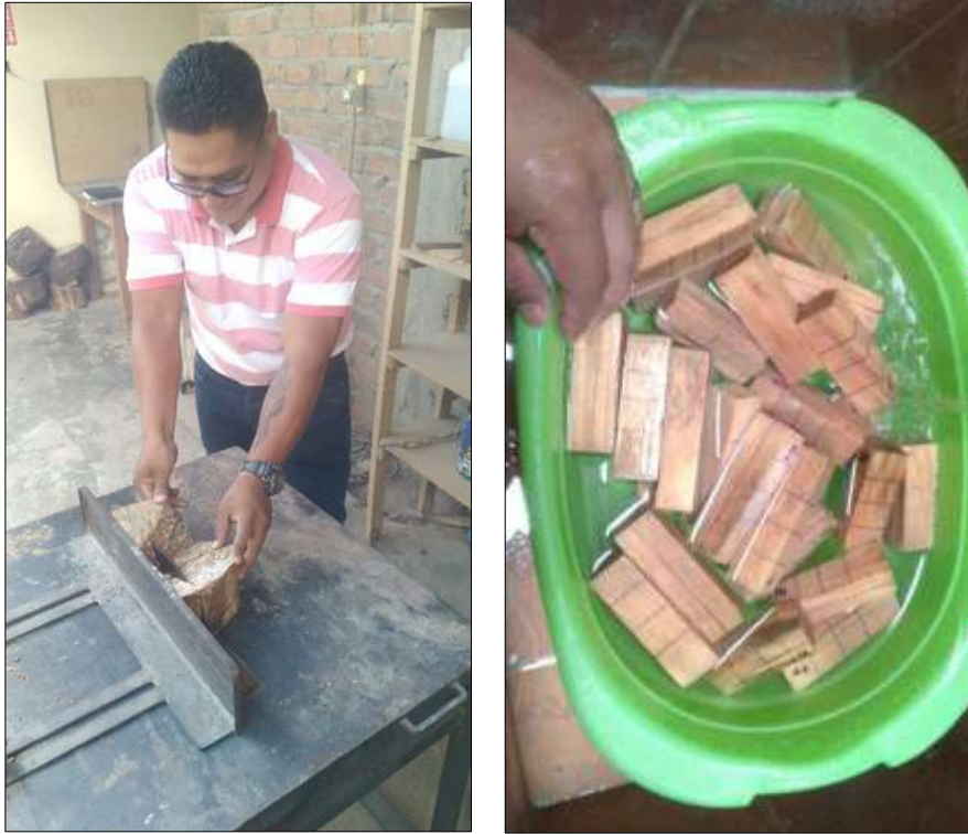
Foto 7. Obtención de probetas para ensayos de propiedades físicas, sobresaturación de las probetas
