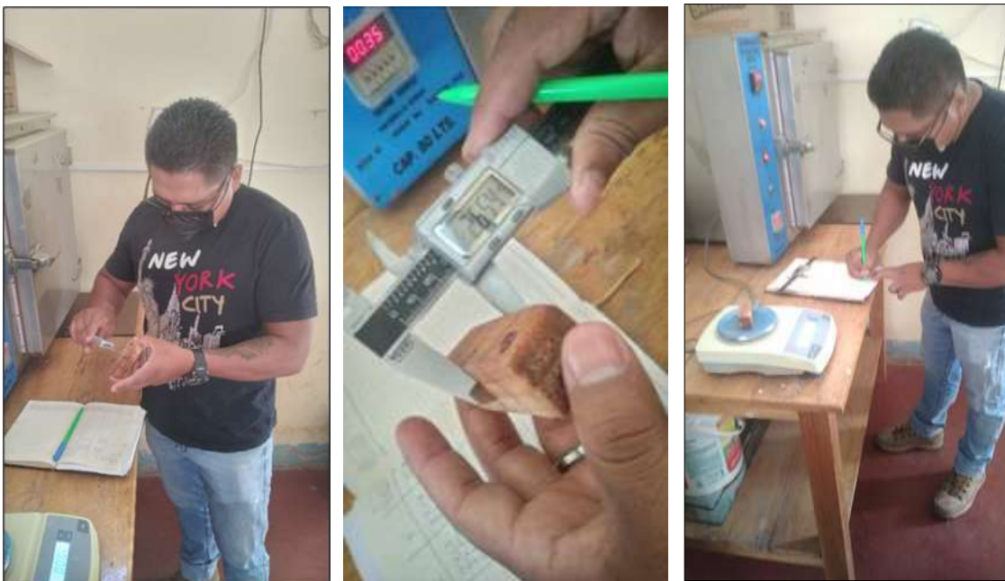
Foto 8. Medición de probetas para calcular las propiedades físicas de la madera
