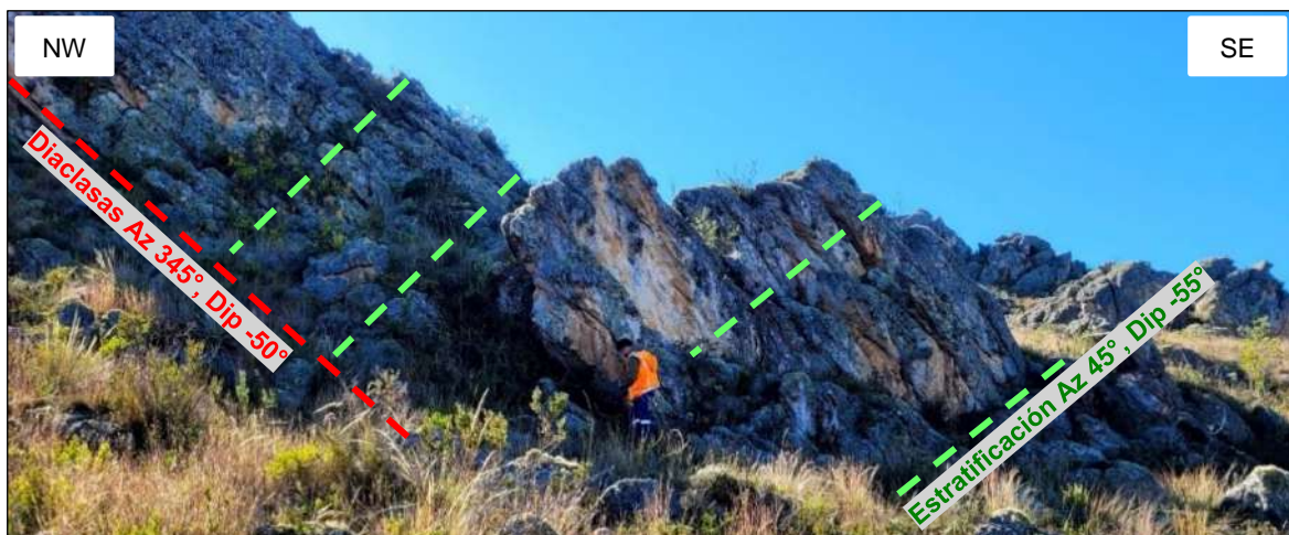
Foto 6. Vista NW-SE en otro afloramiento de la Estación 3, observándose presencia de arenisca de la Formación Farrat con Az 45^\circ , Dip -55^\circ y familia de diaclasas con Az 345^\circ , Dip -50^\circ .
