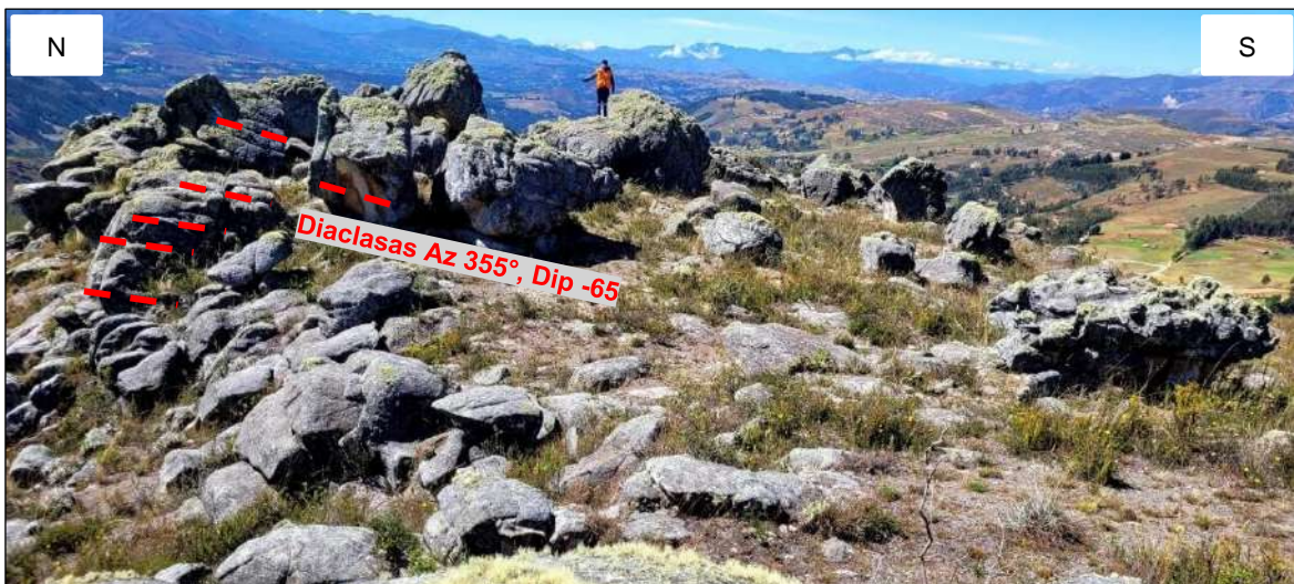
Foto 42. Fotografía con vista N-S apreciándose grandes bloques de arenisca algunos rodados y otros insitu con fracturamiento Az 355°, Dip -65°.
