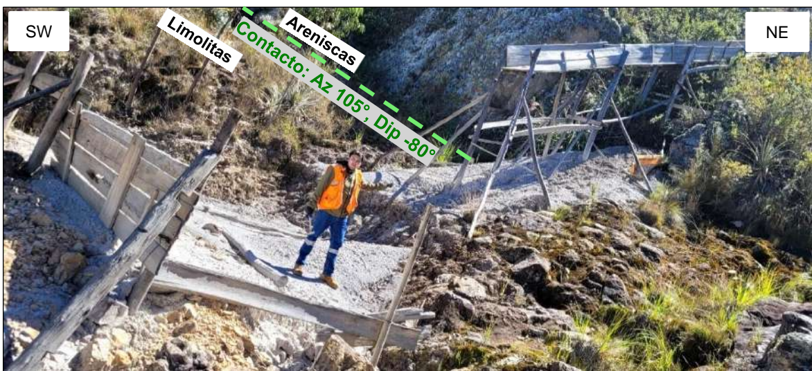
Foto 96. En la Estación 31 se identificó instalaciones de cantera artesanal para extracción de Caolín, así mismo se puede apreciar contacto entre arenisca y limolitas con Az 105° y Dip -80°. Coordenadas: Norte: 9204525.02, Este: 790035.45, Elevación: 3006.99
