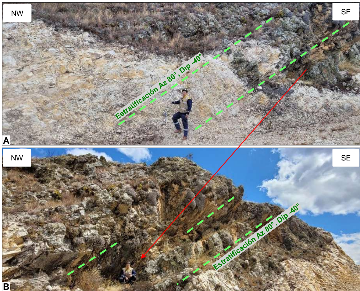
Foto 89. En (A) y (B) se muestran vistas NW-SE en afloramientos de arenisca en corte de carretera en Estación 9, con Az 80°, Dip -40°. Con las coordenadas: Norte: 9205351.49, Este: 790160.90, Elevación: 3108.21.
