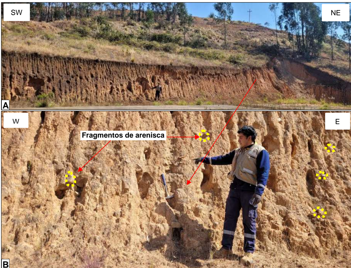
Foto 94. En (A) y (B) se aprecia depósitos cuaternarios inconsolidados compuestos por niveles de arenas finas y conglomerados con matriz arenácea y fragmentos de areniscas con las siguientes coordenadas: Norte: 9204271.75, Este: 790899.57, Elevación: 2968.74.
