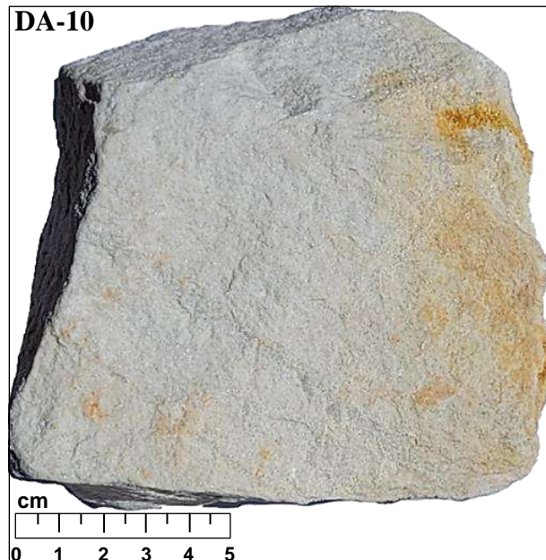
Foto 26. Muestra de arenisca DA-10 para pruebas de densidad por método de parafina, obsérvese dominio en contenido de cuarzo color blanco y menor cantidad de pátinas de óxidos de hierro.
