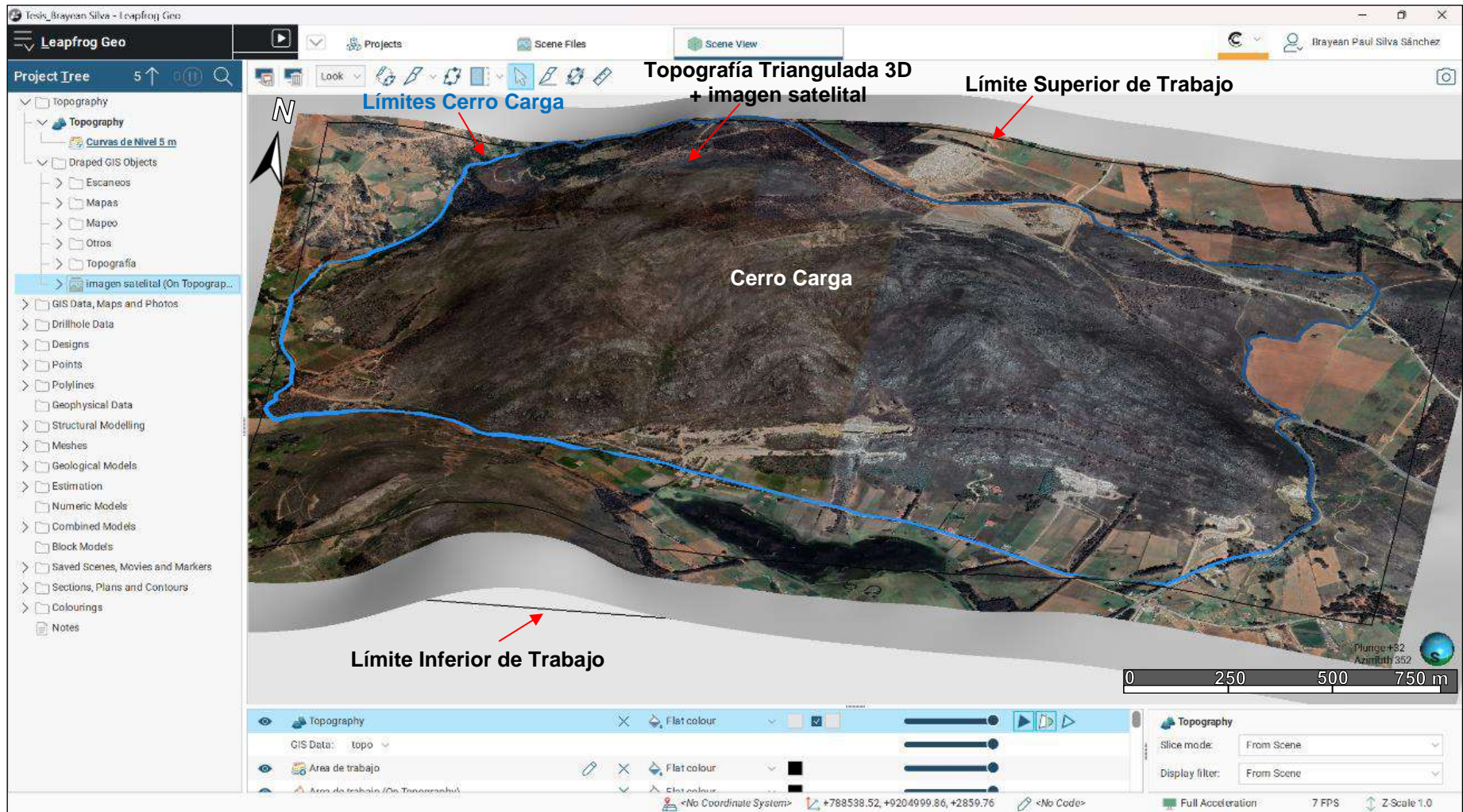
Figura 23. En las figuras se observa interfaz del Software Leapfrog Geo 2023.2.3, mostrando los límites superiores, inferiores, límites circundantes y topografía triangula 3D con la imagen satelital superpuesta del Cerro Carga para realización del modelo geológico.
