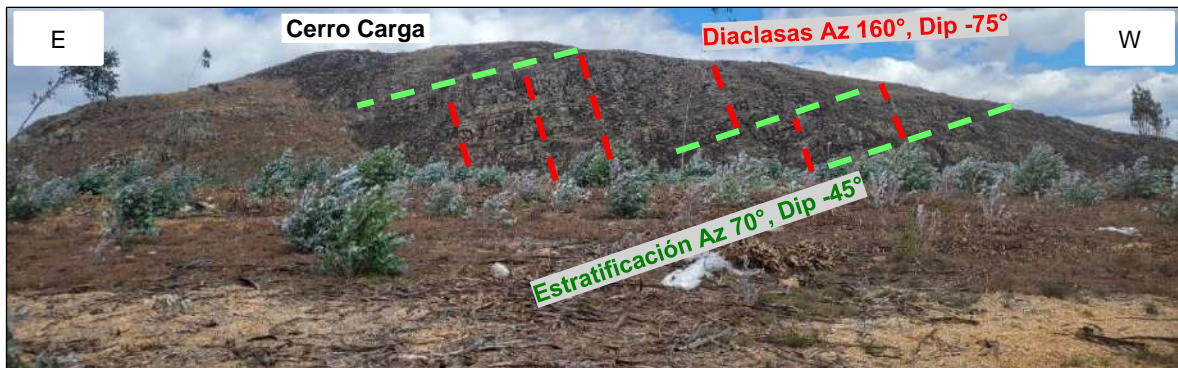
Foto 16. Fotografías con vista E-W, arriba afloramientos de arenisca con Az 70^\circ y Dip -45^\circ y diaclasas con Az 160^\circ y Dip -75^\circ , la fotografía inferior corresponde al mismo sector observando al tesista realizando el cartografiado geológico.
