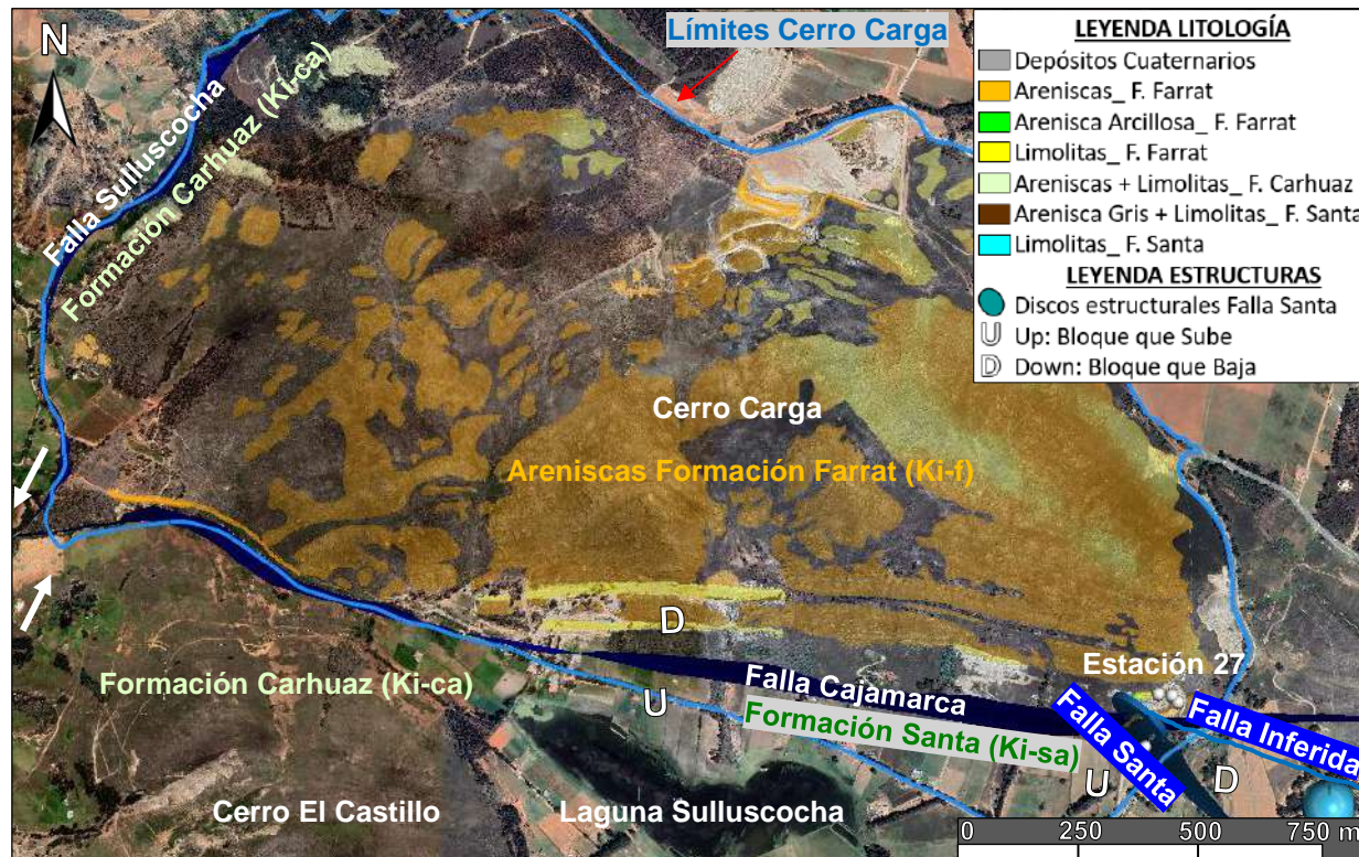
Figura 33. Modelamiento 3D de Falla Santa e Inferida con software Leapfrog Geo 2023.2.3 usando discos estructurales y criterios de interpolación a partir de cartografiado.
