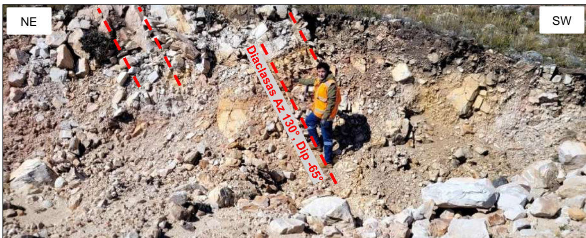
Foto 8. Vista NE-SW en afloramiento de la Estación 4, arenisca de la Formación Farrat con fracturamiento Az 130°, Dip -65°.
