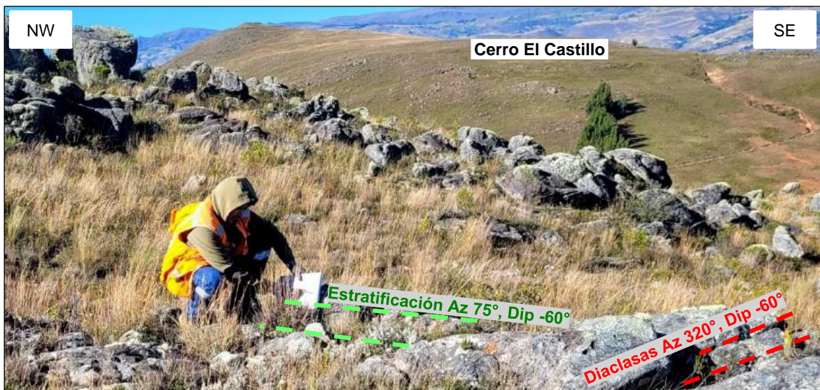
Foto 12. Vista NW-SE, afloramientos de arenisca en la Estación 6, estratificación Az 75°, Dip -60° y fracturamiento Az 320°, Dip -60°, en la parte trasera se aprecia el Cerro el Castillo.
