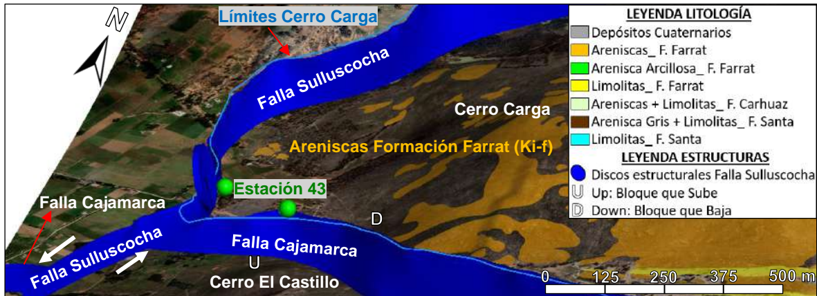
Figura 28. Vista en 3D del Modelamiento de la Falla Sulluscocha con software Leapfrog Geo 2023.2.3, obsérvese interpretación al SW en proyección fuera del área de estudio de como esta falla sinistral Sulluscocha desplaza a la Falla Cajamarca.
