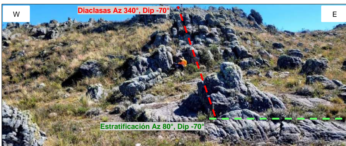
Foto 3. Vista WE en afloramiento de la Estación 1, observándose areniscas de la Formación Farrat con Az 80^\circ , Dip -70^\circ y familia de diaclasas con Az 340^\circ , Dip -75^\circ .
