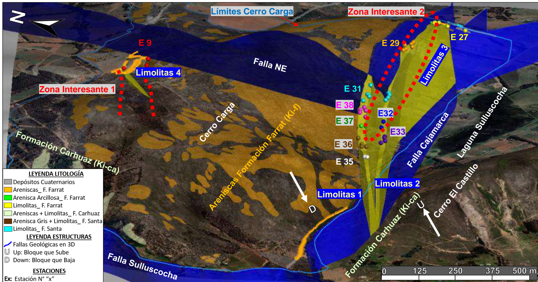
Figura 42. Vista en 3D de sólidos en color amarillo de los 4 cuerpos de Limolitas de la Formación Farrat identificados y generados en Leapfrog Geo 2023.2.3 con soporte de las estaciones de cartografiado, se aprecia, además unión del cuerpo Limolitas 2 y Limolitas 3 siguiendo Azimut N° 110 y proyección e interpolación logrando encontrar la continuidad en la estación 27 al SE del Cerro Carga, además se observa zonas interesantes 1 y 2 para continuar trabajos de exploración y dar continuidad a las limolitas.
