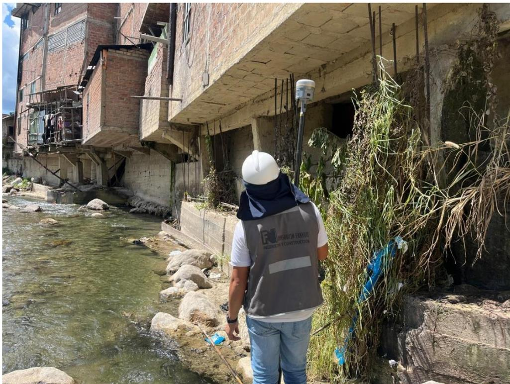
**Figura 92** Lectura de secciones transversales del río Jalqueño
