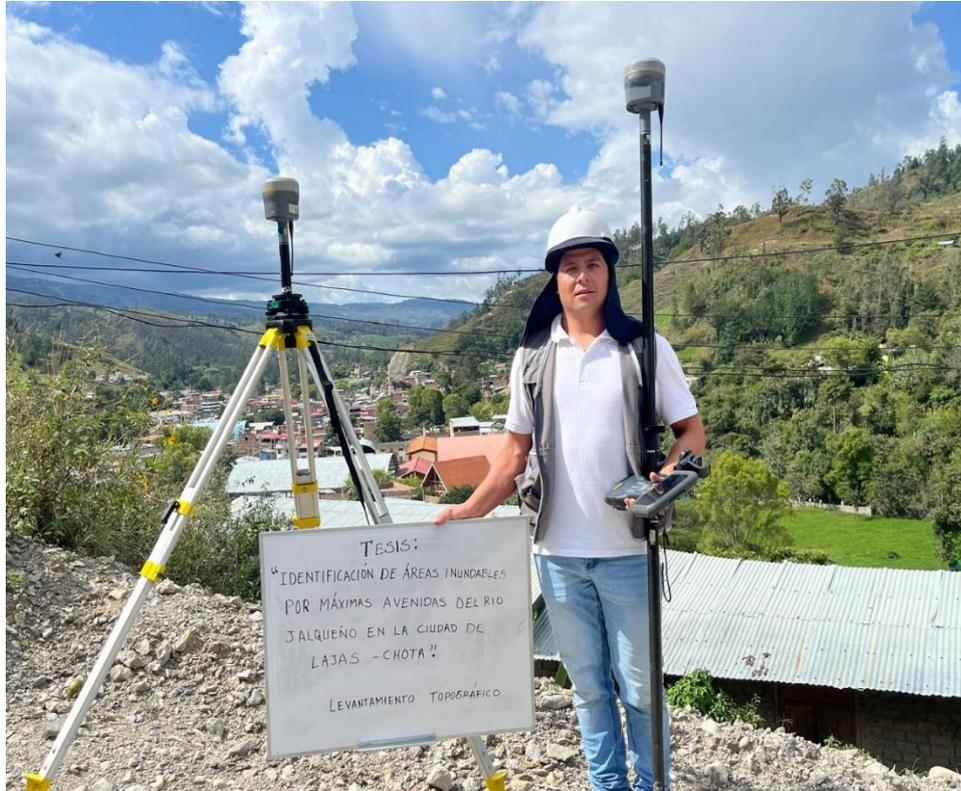
**Fotografía 2.** *Proceso del levantamiento de puntos topográficos*
