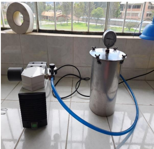
Bomba de vacío
