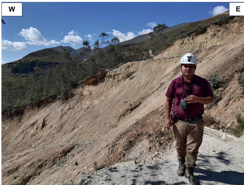
Figura 3.15. Proyección del deslizamiento por formarse: Zanja de coronación y agrietamiento, paralelos a la subsidencia de orientación SSE-NNW, afectando al cementerio del caserío Yanivilca.
