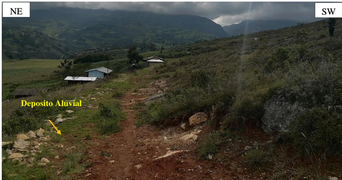
Figura 3.14. Depósito Aluvial de consistencia firme, humedad natural semiseca, estructura fisurada, tenacidad y plasticidad: Alta, color castaño, composición limo-arcillosa, plasticidad: Alta, cementación moderada y resistencia media, cubriendo a la roca caliza. Coordenadas: N9°255,262, E770,505 y H2,936.
