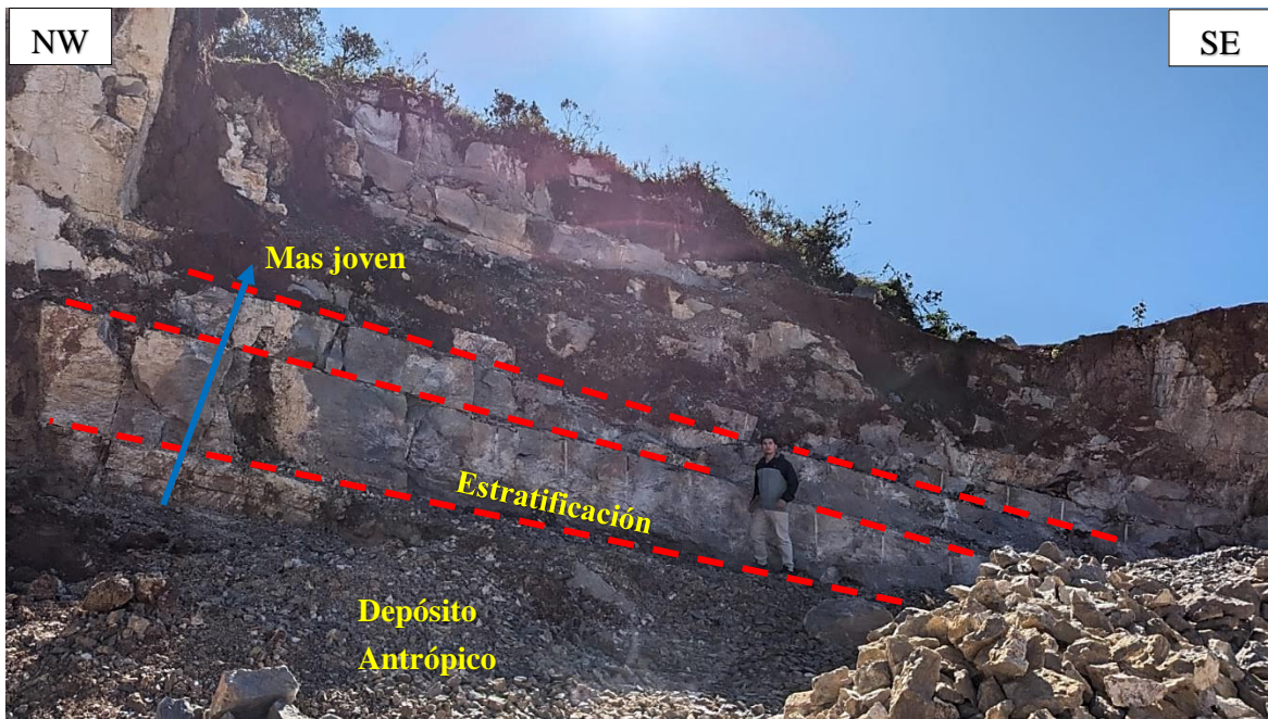
Figura 3.5. Tajo de explotación del frente del tajo este, conformado por bancos de secuencias estratigráficas de roca caliza.
