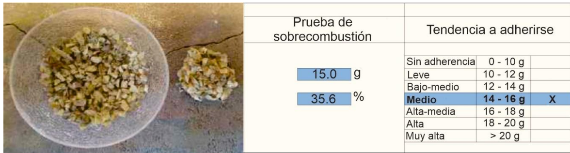
Figura 3.4. Prueba de sobrecombustión a 1300 °C.
