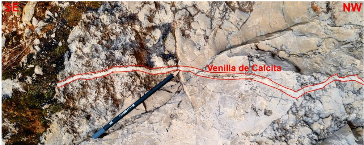
Foto 3.7. En la foto se observa una venilla de calcita en la Formación Cajamarca, con N145^\circ de rumbo y 44^\circ SW de buzamiento.
