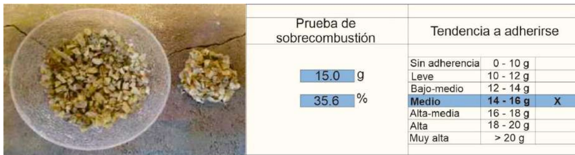
Figura 3.4. Prueba de sobrecombustión a 1300 °C.
