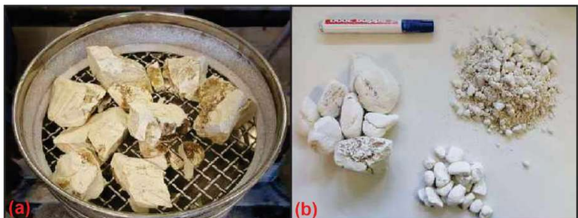
Foto 3.10. (a) Muestra de cal calcinada a 1050°C durante 3h. (b) Muestra de cal tras la prueba de degradación.
