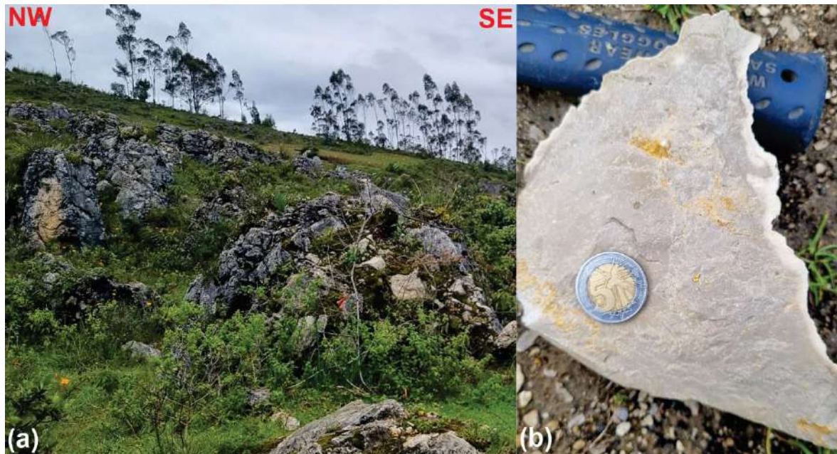
Foto 3.4. (a) Afloramiento de calizas macizas de la Formación Cajamarca. (b) Muestra de mano de roca caliza, que según la clasificación visual de Dunham es una caliza mudstone.
