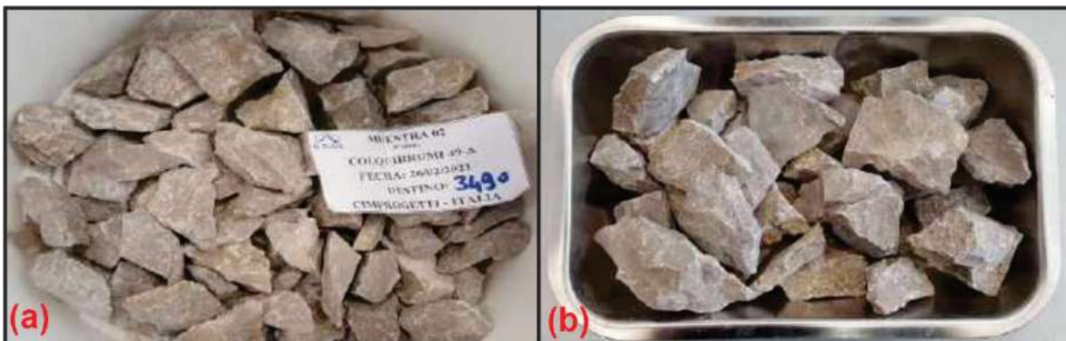
Foto 3.9. (a) Muestra de roca carbonatada tal como se recibió. (b) Muestra de roca carbonatada tras la trituración.
