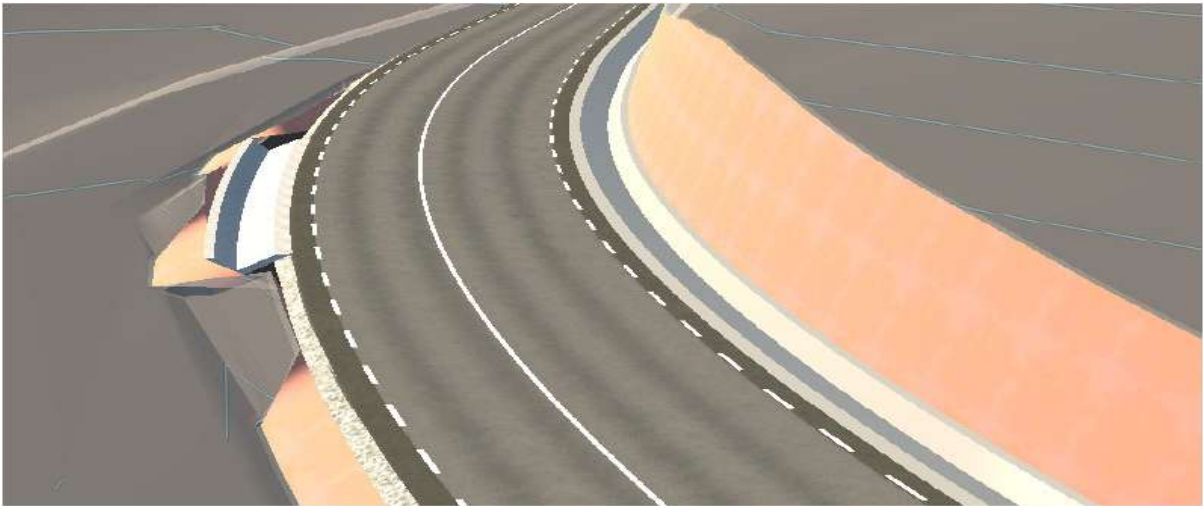
Figura N° 48: Tramo de cuneta innecesaria
