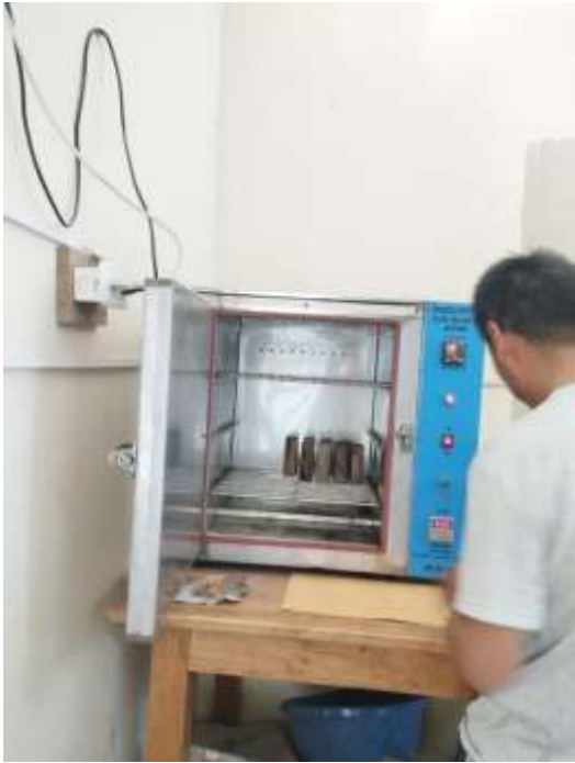
Fotos 12 y 13. Medición de las propiedades físicas en seco.
