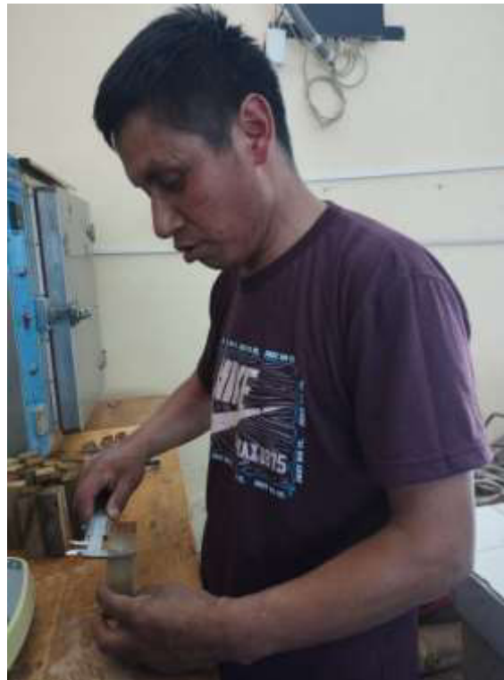
Fotos 8 y 9. Medición de las propiedades físicas en húmedo.
