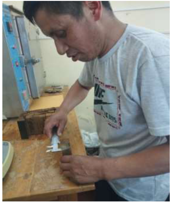
Fotos 12 y 13. Medición de las propiedades físicas en seco.
