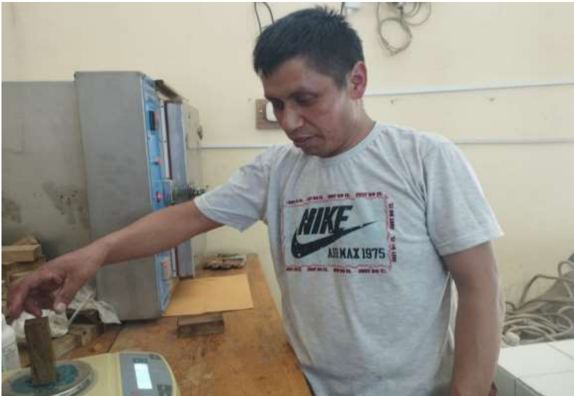
Fotos 14 y 15. Peso de las muestras de las propiedades físicas en seco.
