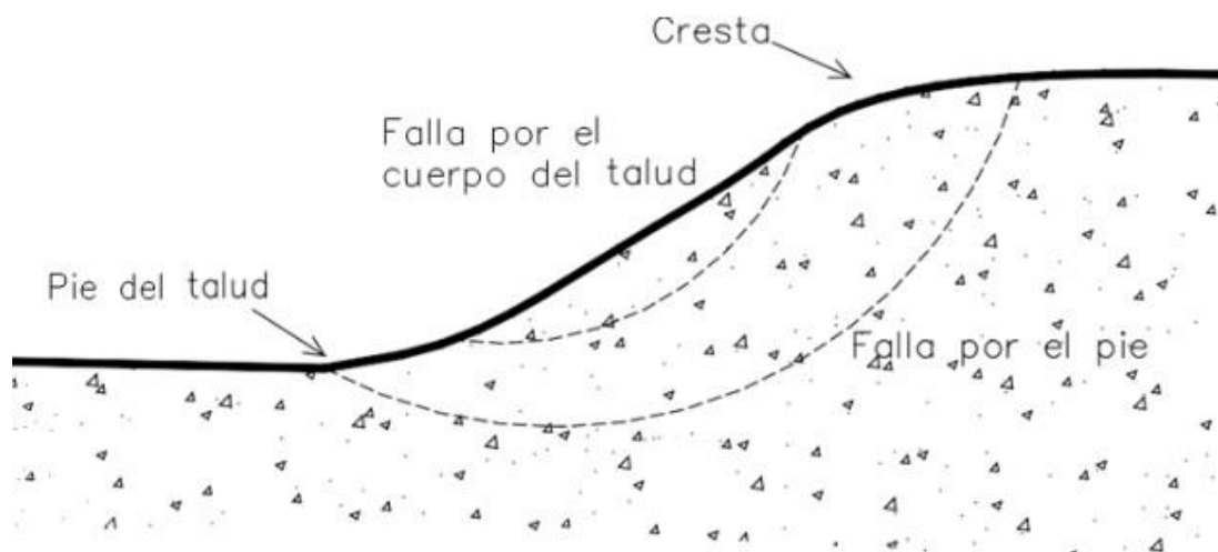
Figura 2. Falla en un talud
