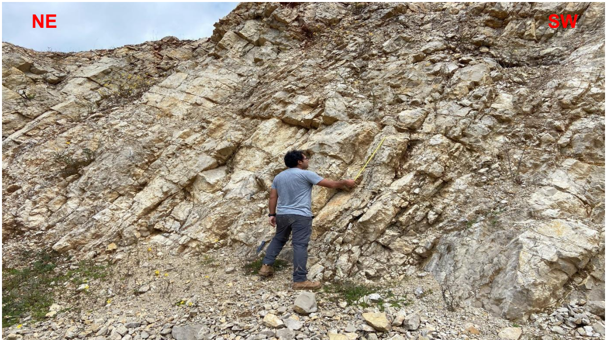
Foto 4. Estación geomecánica 02, medición de la persistencia.
