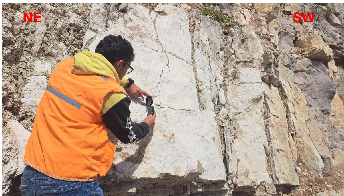
Foto 7. Estación geomecánica 05, midiendo dip y dip direction
