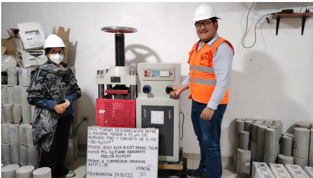
Fotografía 04. Tesista y asesora con la máquina de compresión uniaxial ensayando probetas cilíndricas de concreto .
