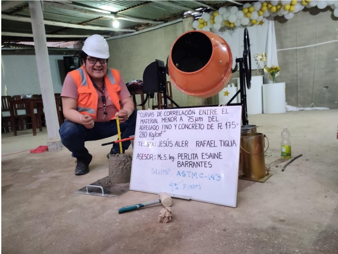
Fotografía 02. Tesista midiendo el asentamiento del concreto
