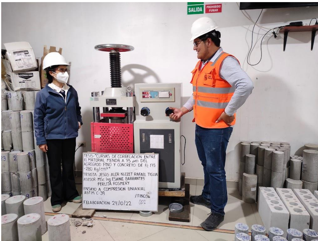
Fotografía 06. Tesista ensayando resistencia a compresión de concreto.
