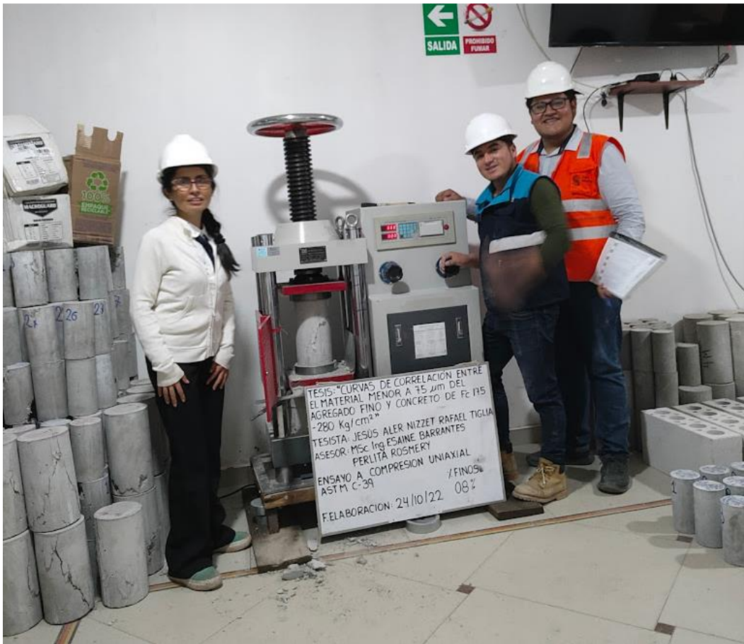
Fotografía 06. Tesista ensayando resistencia a compresión de concreto.
