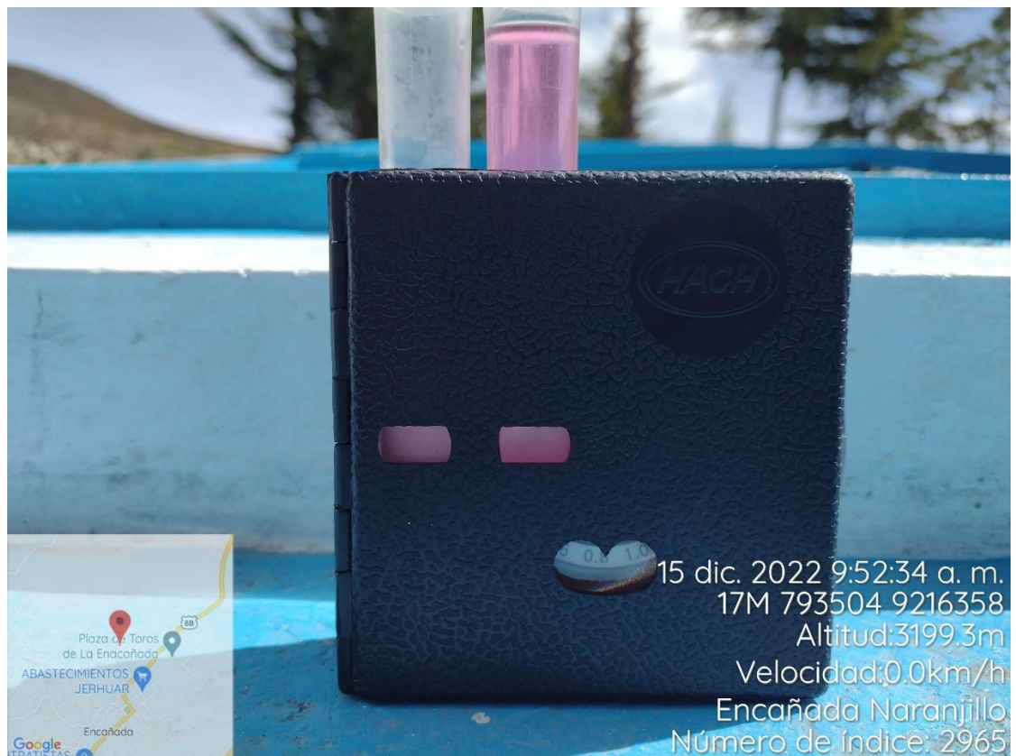
Figura 44 Medición de cloro residual en el reservorio El Naranjillo
