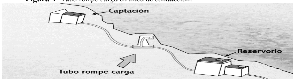
Figura 4 Tubo rompe carga en línea de conducción.
