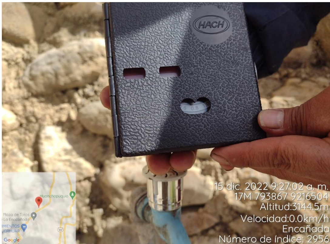
Figura 41 Medición de cloro residual en la primera vivienda del sistema Juancho Puquio.
