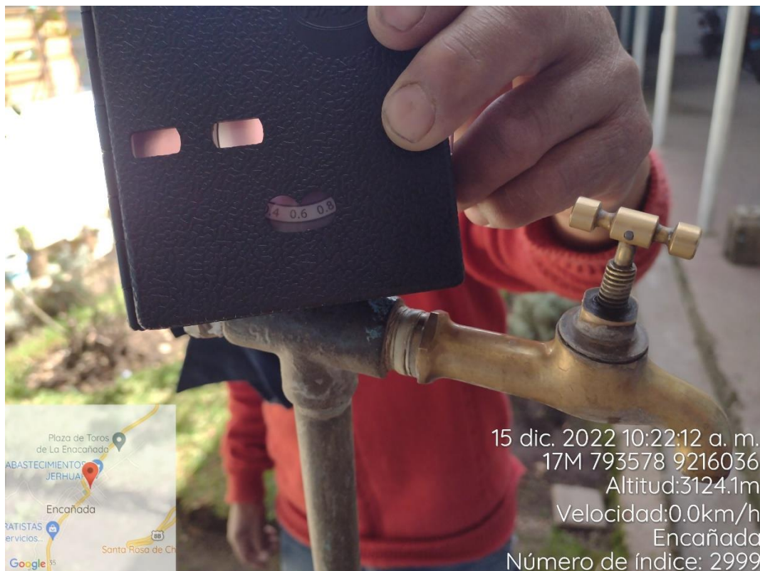
Figura 42 Medición de cloro residual en la vivienda intermedia del sistema Juancho Puquio.
