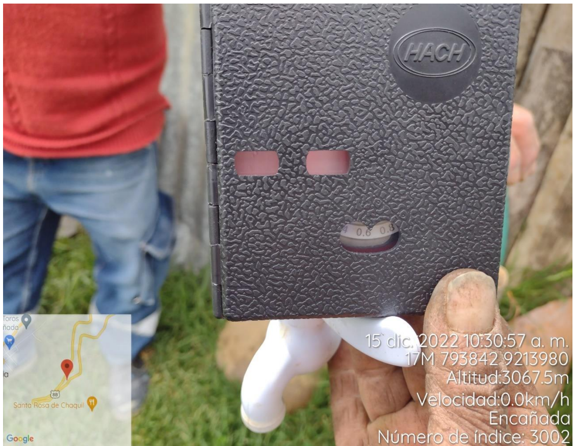
Figura 43 Medición de cloro residual en la última vivienda del sistema Juancho Puquio.
