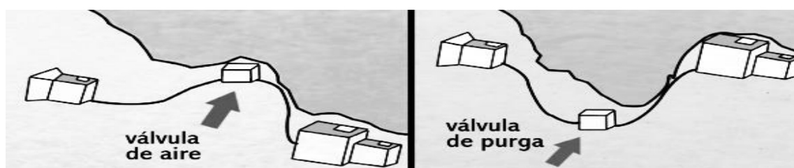
Figura 5 Válvula de aire y válvula de purga en la línea de conducción de agua potable.
