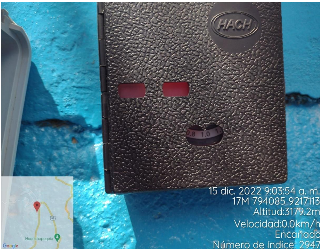
Figura 40 Medición de cloro residual en el reservorio Juancho Puquio
