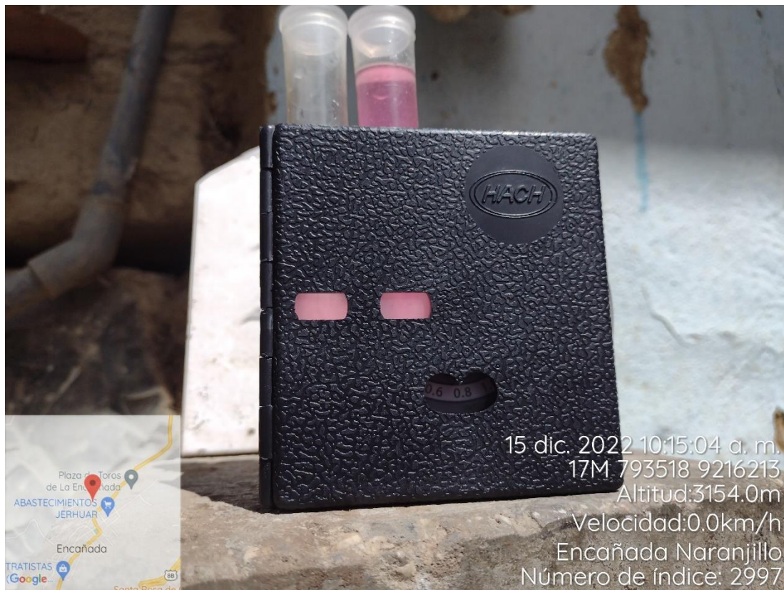
Figura 45 Medición de cloro residual en la primera vivienda del sistema El Naranjillo.
