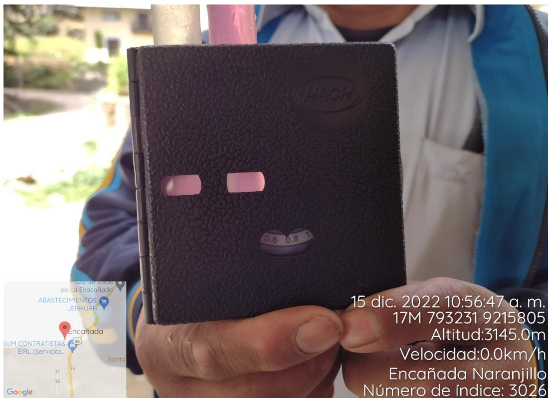
Figura 46 Medición de cloro residual en la vivienda intermedia del sistema El Naranjillo.
