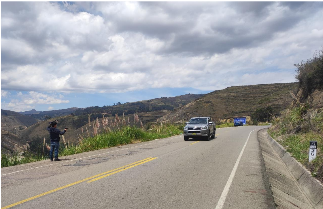
Fotografía N° 16: Medición de Velocidad de Operación, Tangente N°21 (Km- 02+020)
