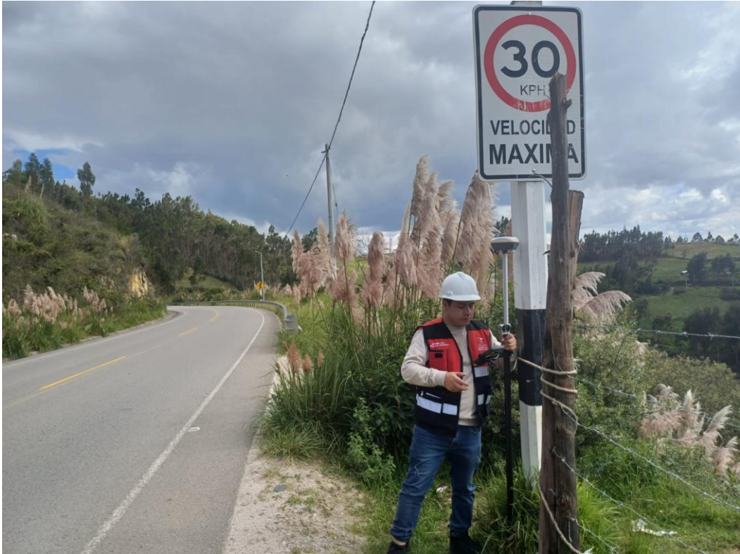
Fotografía N° 7: Levantamiento Topográfico – Toma de datos en señal de tránsito
