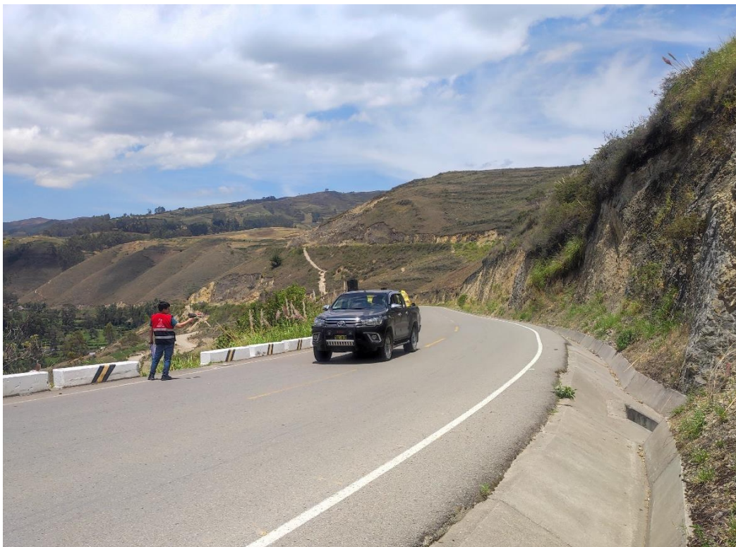
Fotografía N° 14: Medición de Velocidad de Operación, Curva N°16 (Km-01+630)
