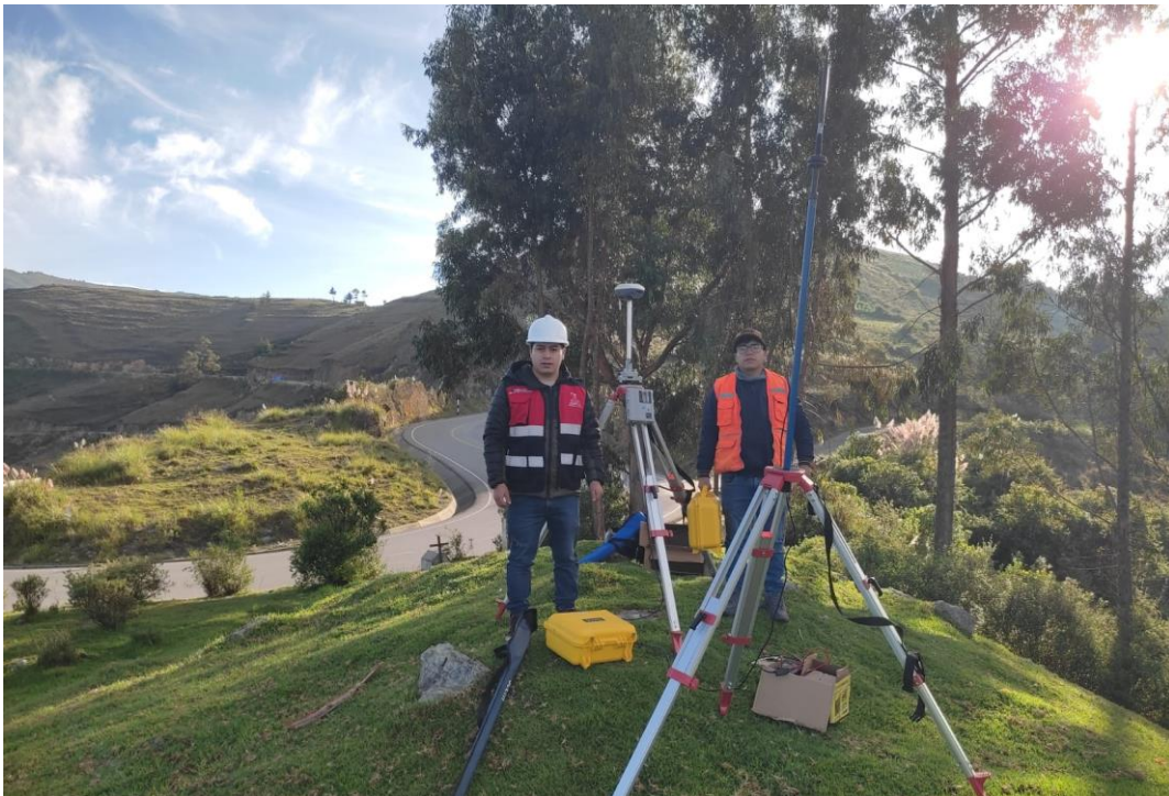
Fotografía N° 2: GPS Diferencial South Galaxy G7 y Equipo de Trabajo
