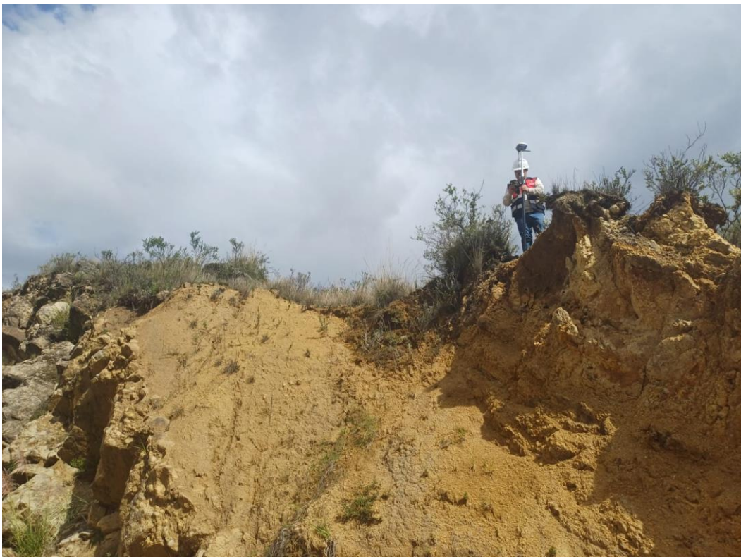
Fotografía N° 8: Levantamiento topográfico – Toma de datos en talud
