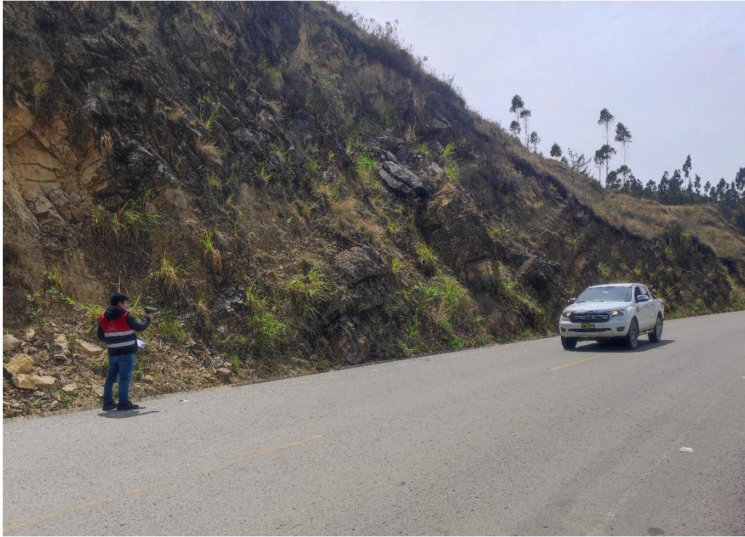
Fotografía N° 11: Medición de Velocidad de Operación, Tangente N°02 (Km- 00+160)
