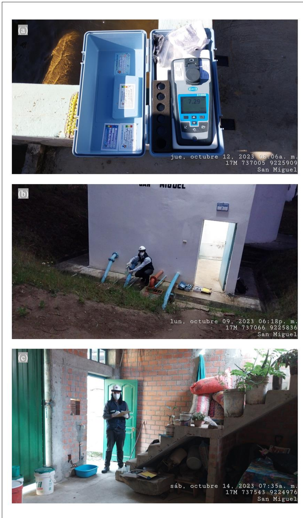
Figura 119: Medición de la turbiedad, cloro residual libre y pH en el SAP San Miguel
