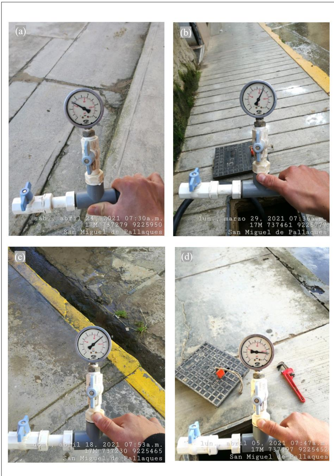
Figura 118: Registro de presiones en la red de distribución del SAP San Miguel
