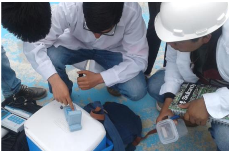
Figura 37. Medición de cloro libre residual en el Reservorio Santa Rosa
