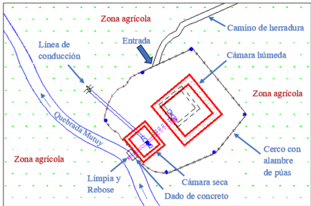
Figura 16. Croquis de la captación de fondo "Santa Rosa", mostrando su entorno geográfico en relación con el sistema de abastecimiento
