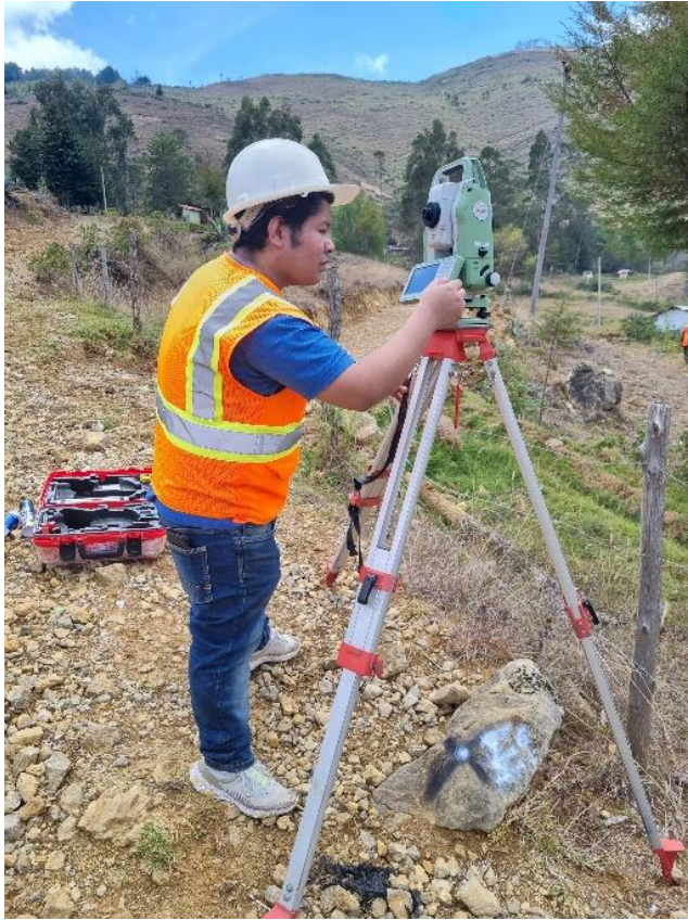
Figura 44. Toma de puntos topográficos del reservorio Santa Rosa y de su cerco perimétrico.
