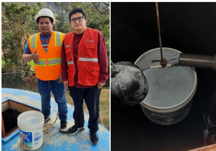
Figura 30. Medición del caudal de agua cruda en la entrada de línea de conducción al reservorio
