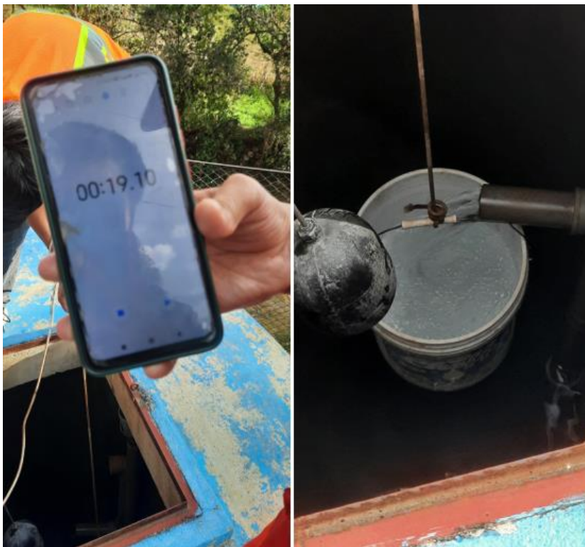
Figura 65. Medición de caudal aplicando el Método Volumétrico: Uso de balde de 18 L y cronómetro para toma de tiempo.
