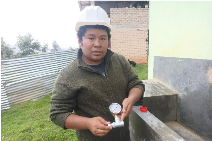
Figura 69. Instalación de manómetros en las viviendas muestrales para medición de presiones.
