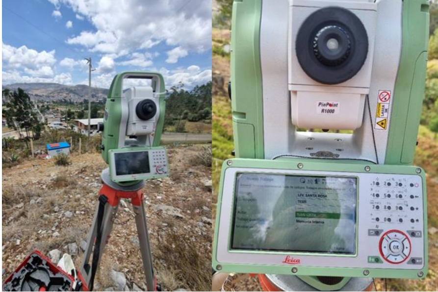
Figura 41. Estación Total LEICA Modelo TS10 3" R1000 usado para el levantamiento topográfico.
