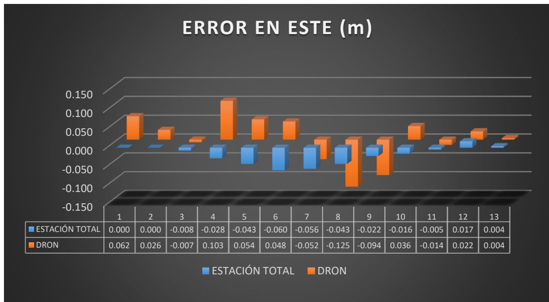
Figura 53: Gráfico N°06. Error en Este Phantom 4 Pro vs Leica TS06 Plus 5”
