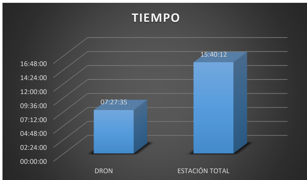
Figura 57: Gráfico N°05. Factor tiempo: Dron Phantom 4 Pro vs Leica TS06 Plus 5"
