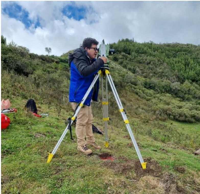
Figura 37: Estacionamiento y orientación para iniciar a radiar los puntos.
