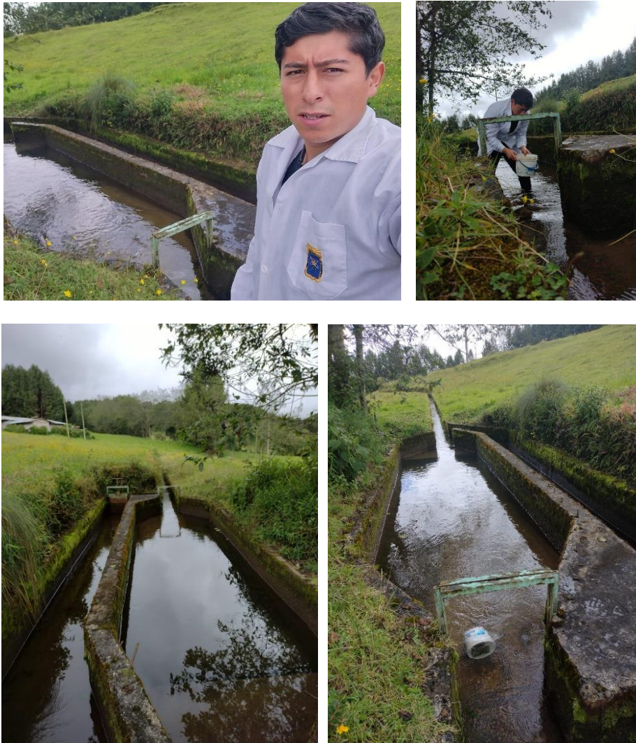
Figura N° 70: Primeras pruebas de la implementación de la metodología de los muestreos de sedimentos en el desarenador
