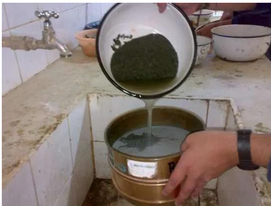
Figura N° 77: Ensayo de granulometría para tamizado en mallas N200 hasta N4, laboratorio G&S ingenieros consultores
