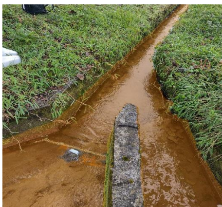
Figura N° 75: Muestras de fondo en la entrada del desarenador con bandeja de dimensiones 15cm x40cm x50cm sumergida durante 15 min en el ensayo in situ.
