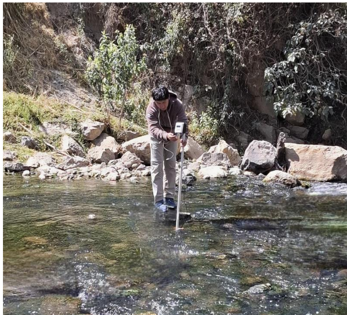
Figura N° 80: Aforo de velocidades en la quebrada Ramírez
