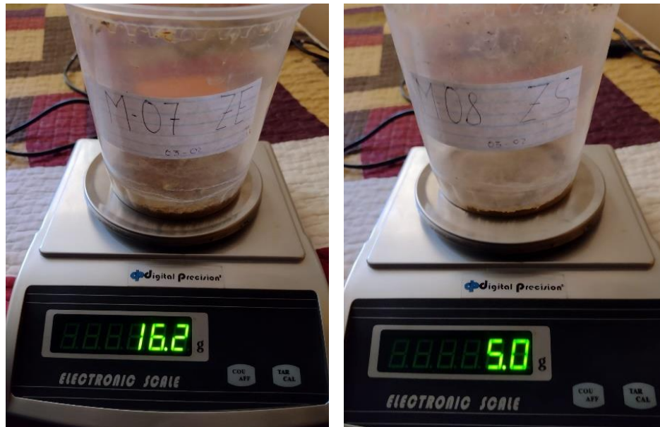
Figura N° 78: Pesaje de material secado, tanto de la zona de entrada y salida del desarenador.
