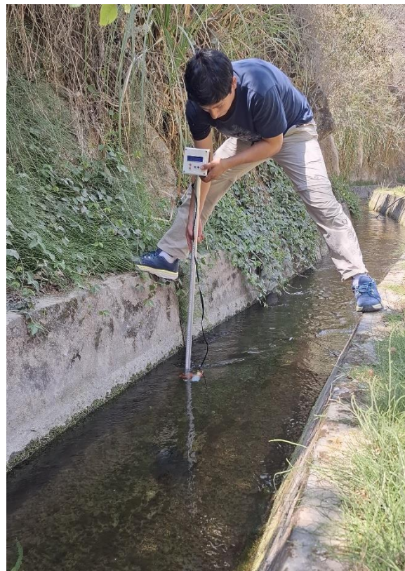
Figura N° 79: Aforo de caudales en canal de conducción al desarenador de la MCH con correntómetro FM-100V5 de marca Shenzhen Aermada
