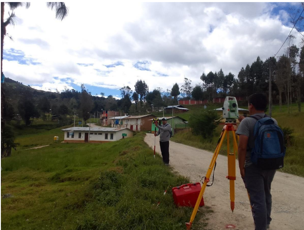
Figura 23: levantamiento topográfico del sistema de agua potable
