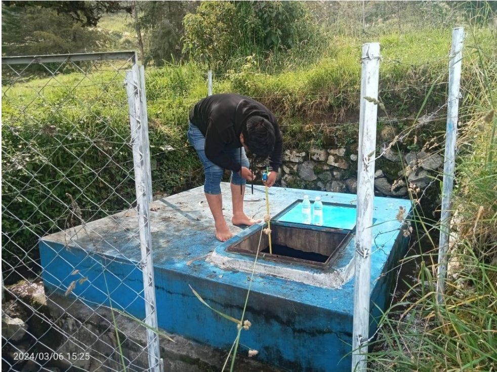
Figura 19 Muestras de agua para llevarlo a analizar al laboratorio
