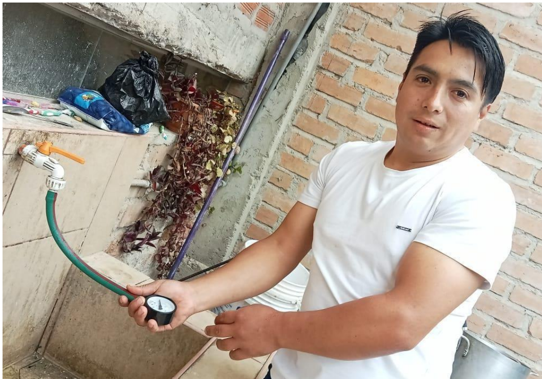
Figura 25: Midiendo la presión en las conexiones domiciliarias del C.P. el Romero
