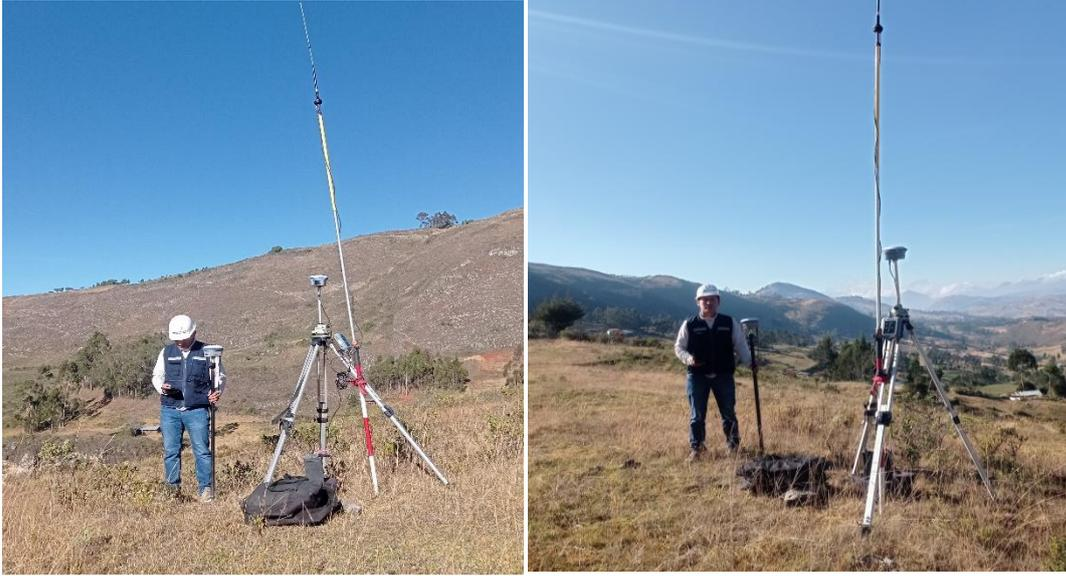
Nota: La fotografía muestra la instalación e inicio del levantamiento topográfico mediante GPS DIFERENCIAL CHCNAV i90
