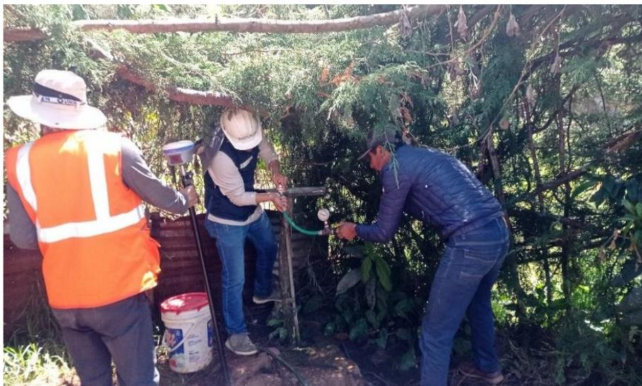
**Fotografía 21.** *Mediciones de la presión dinámicas en campo de la vivienda V20 del SAP del caserío de Quinumayo*
