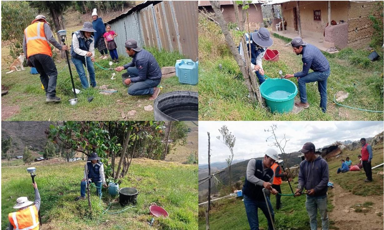
Nota: La fotografía muestra las presiones tomadas en las viviendas de los sistemas de agua potable durante el periodo de investigación, con ayuda del manómetro de marca Shunjay.
