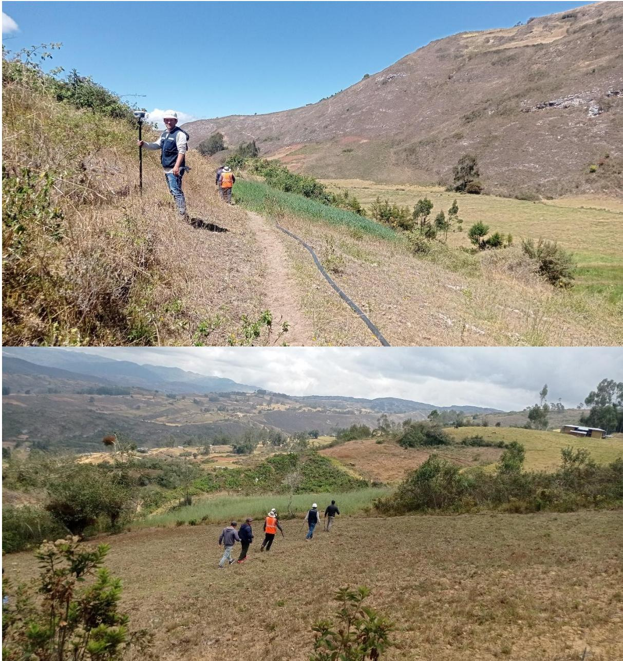
Nota: La fotografía muestra el levantamiento topográfico con GPS DIFERENCIAL CHCNAV i90 en toda la red de distribución de los dos sistemas.
