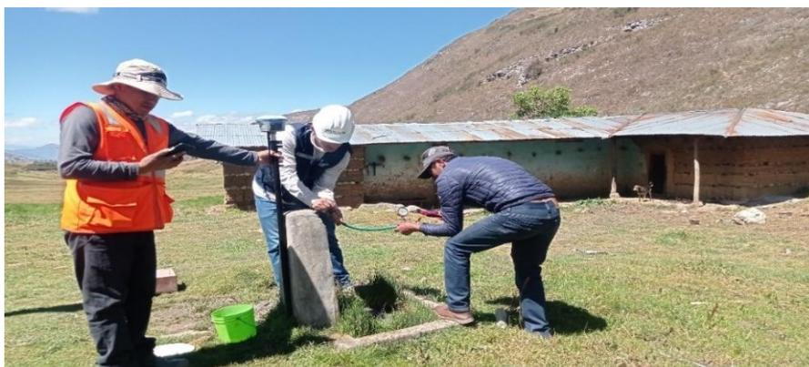
**Fotografía 17.** *Mediciones de la presión dinámica en la vivienda V66 del SAP de los Caseríos de Nueva Libertad y parte alta de Quinuamayo*
