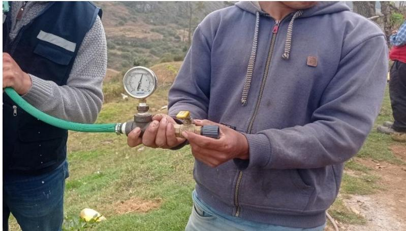
**Fotografía 18.** *Mediciones de la presión dinámica en la vivienda V41 del SAP de los Caseríos de Nueva Libertad y parte alta de Quinuamayo*
