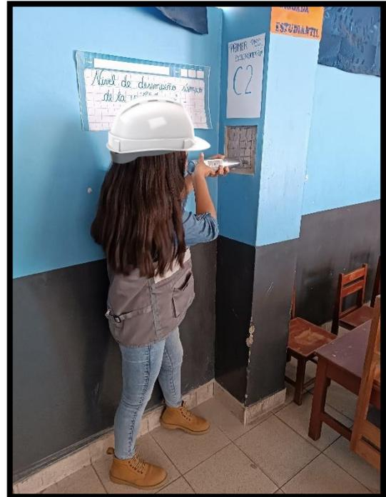
**Descripción:** Para el ensayo en ambas columnas, se tomaron 12 rebotes, en una dirección de  $90^\circ$  con el esclerómetro en un cuadrado de 20 cm x 20 cm.
