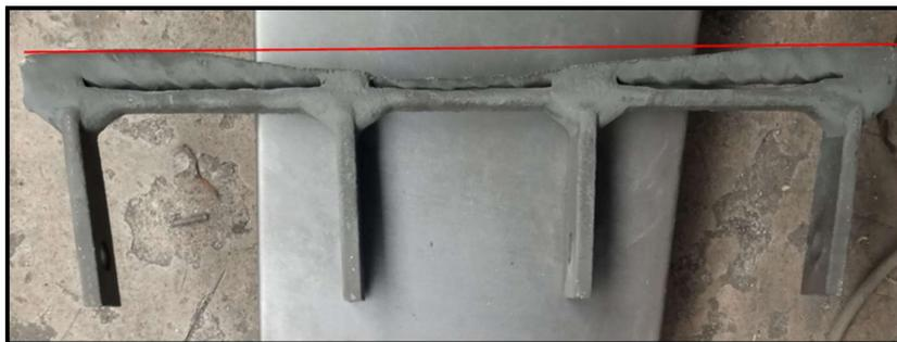
Figura 28: Martillo utilizado en el proceso de conmiución de minerales con el diseño de abastecimiento inicial (Mayor desgaste en el centro).
