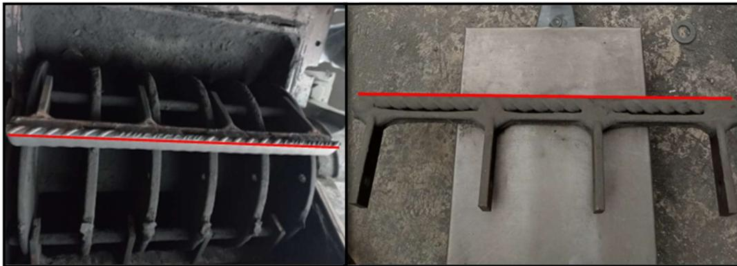
Figura 41: Martillos utilizados en el proceso de conminución de mineral con el diseño propuesto (Desgaste uniforme en el centro y laterales)
