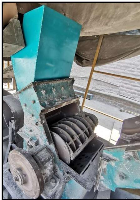
Figura 21: Vista de acoplamiento real para el primer diseño.
