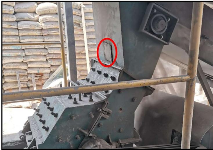
Figura 27: Rotura por efecto abrasivo de los impactos del mineral.
