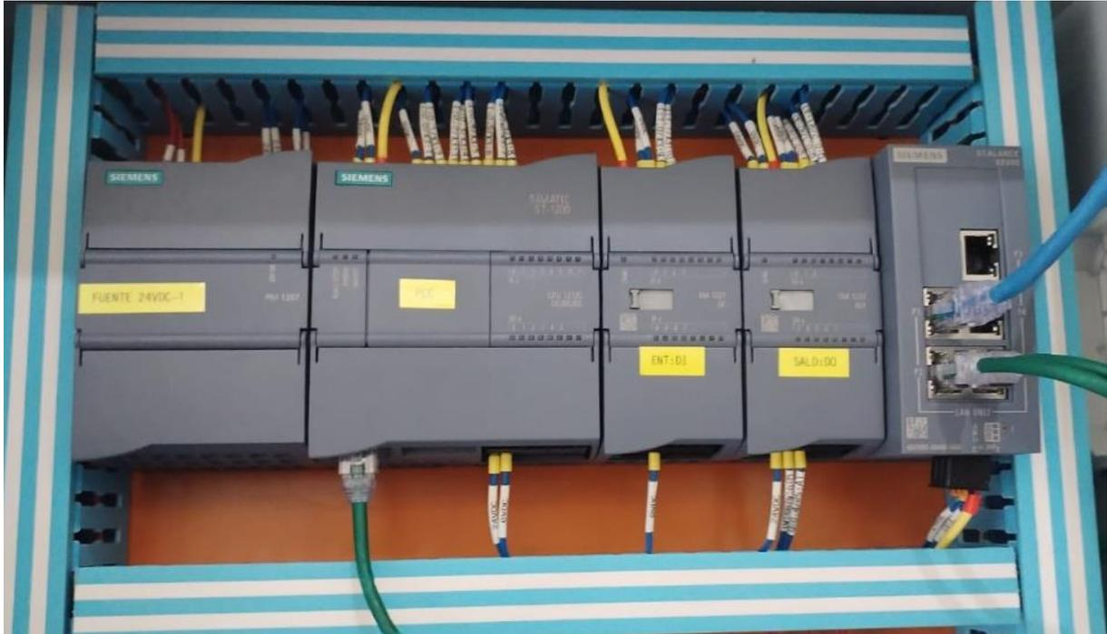
Fig. 53: Instalación de controlador y switch en estación 1.
