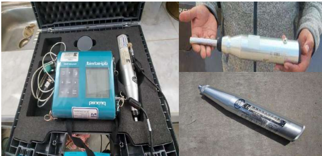
Foto 1. Martillo Schmidt utilizado para la medición de resistencia de compresión simple.
