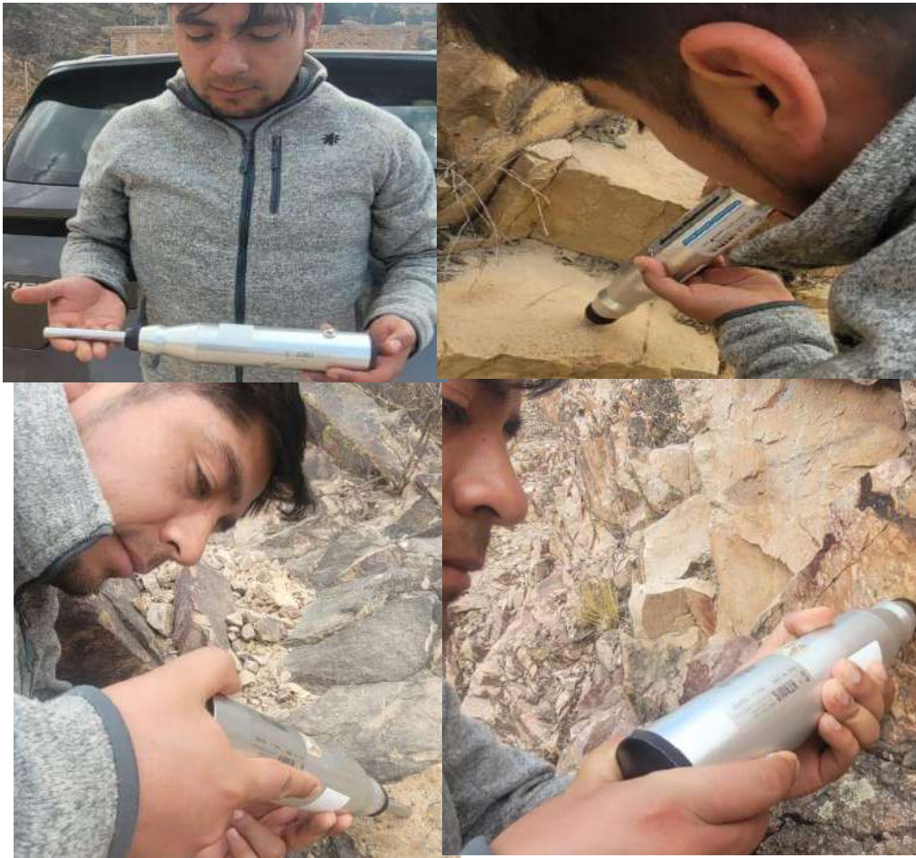
Foto 6. Uso del martillo de Schmidt en la formación Farrat por el tesista, en las diferentes posiciones. Localidad de Miraflores, Celendín.
