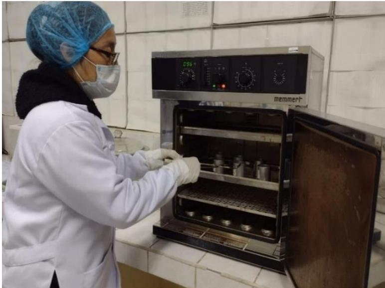
*Nota.* La imagen muestra la determinación de humedad en estufa.
