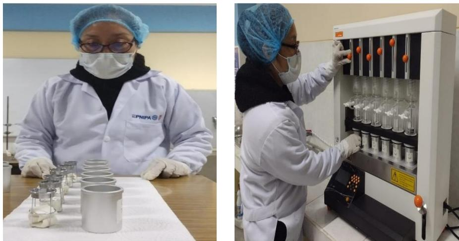
*Nota.* La imagen muestra la determinación de grasa cruda y cocida usando el método Soxhlet.
