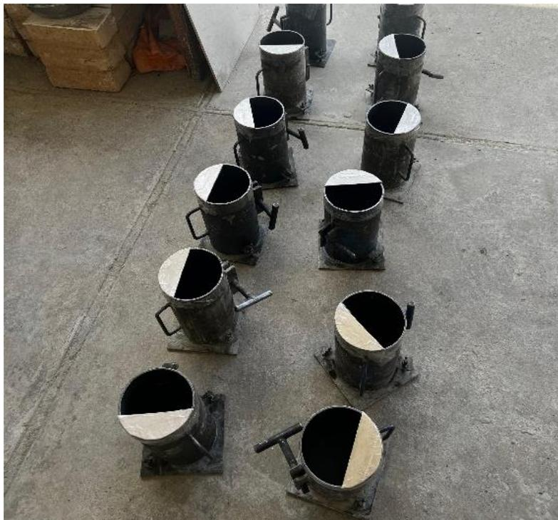
**Figura 49.** Aplicación de adhesivo epóxico Mapei Eporip en probetas con ubicación de la junta a 20 cm de base.
