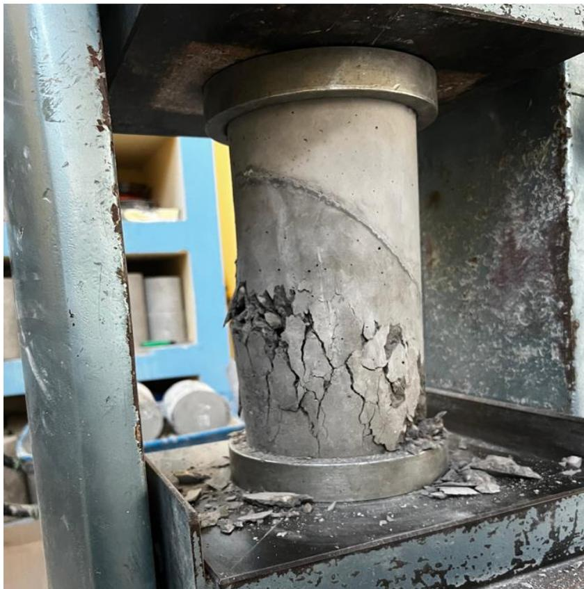
**Figura 57.** Fractura de tipo 3 en probeta B3 ensayada a 7 días de curado
