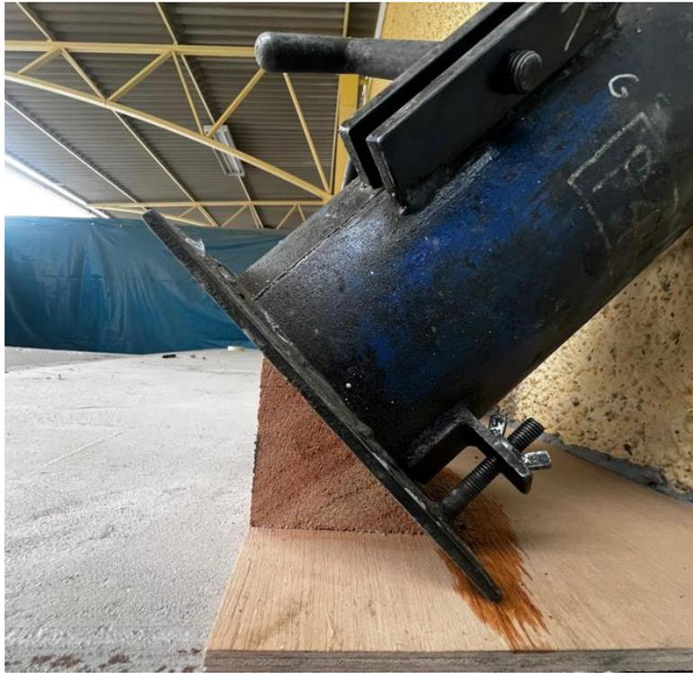
**Figura 60.** *Aplicación del adhesivo epóxico Mapei Eporip en junta fría de probetas B2.*
