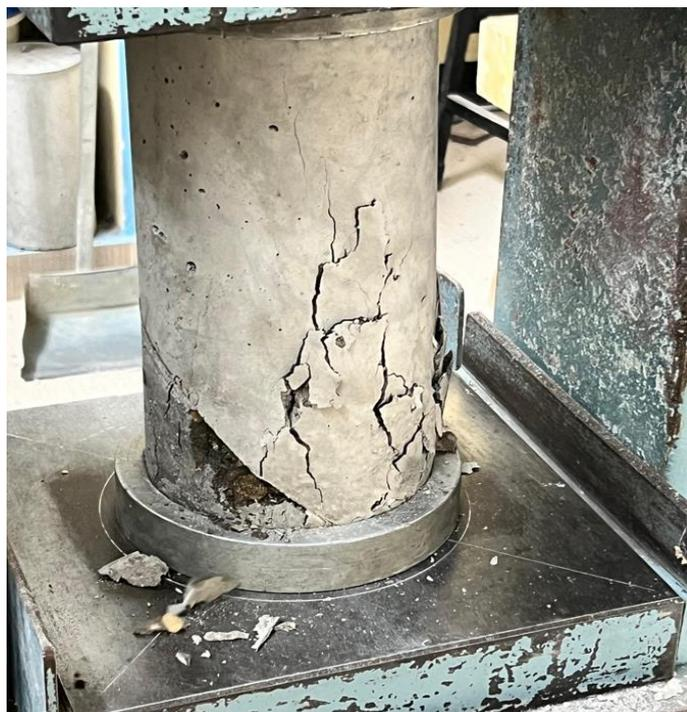
**Figura 58.** Ensayo de resistencia a la compresión efectuado en probetas patrón ensayado a 3 días de curado.
