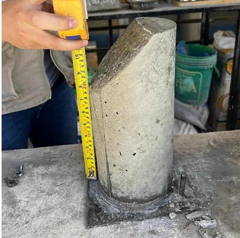
**Figura 48.** Preparación de moldes cilíndricos utilizando tapas de cartón prensado en la parte superior para probetas con junta a 20 cm de la base.
