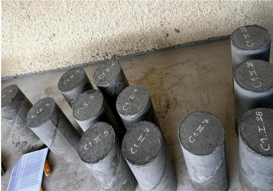
**Figura 56.** Fractura de tipo 2 en probeta C1 ensayada a los 7 días de curado
