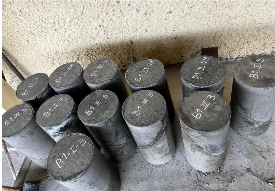
**Figura 54.** Grupo de probetas B1, con puente adherente Mapei Eporip ubicado a 5 cm de la base
