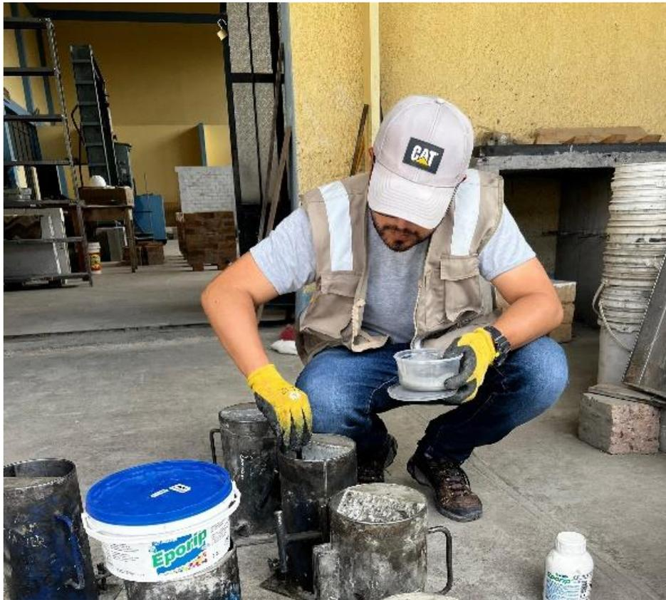
**Figura 50.** Curado de probetas patrón (Grupo A).
