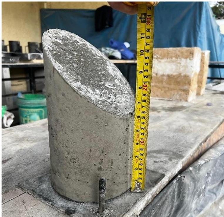
**Figura 47.** Primera etapa de baseado de concreto después de 24 horas de curado con junta a 20 cm de la base y ángulo de inclinación a 45°.
