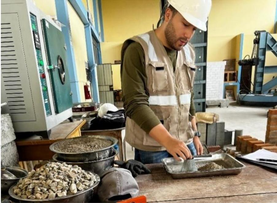
**Figura 42.** *Peso unitario compactado del agregado grueso.*
