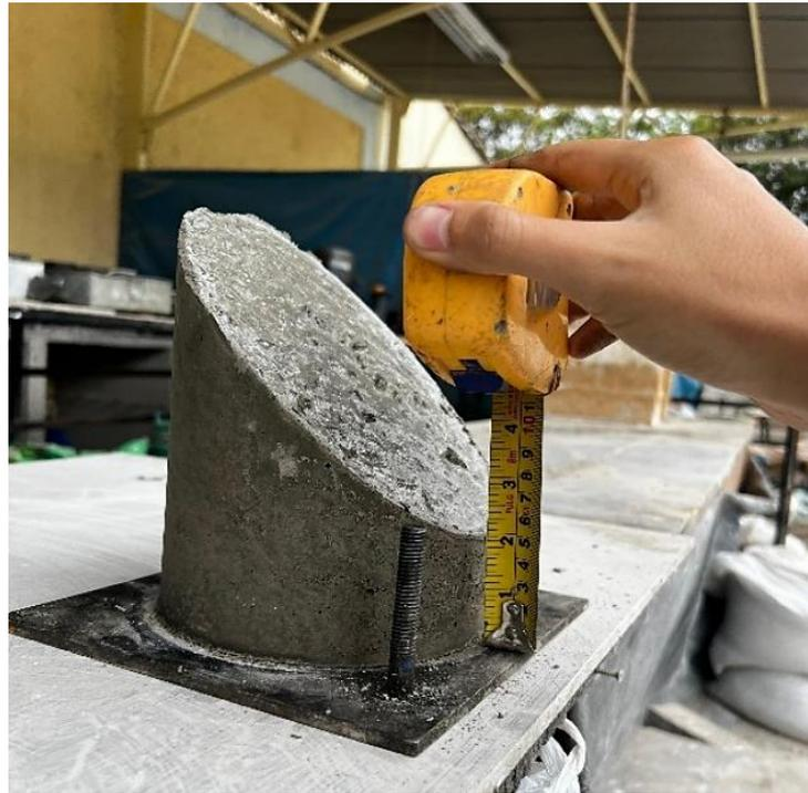
**Figura 46.** Primera etapa de baseado de concreto después de 24 horas de curado con junta a 15 cm de la base y ángulo de inclinación a 45°.
