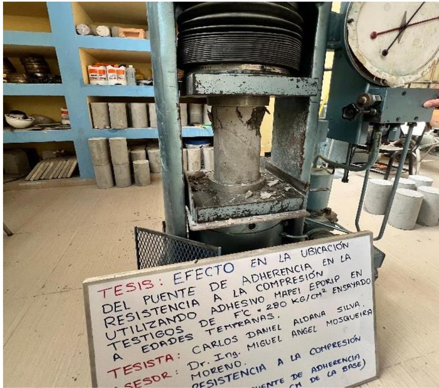
**Figura 52.** Ensayo de resistencia a la compresión efectuado a probetas C1 con junta a 15 cm de la base, acompañado del ingeniero asesor
