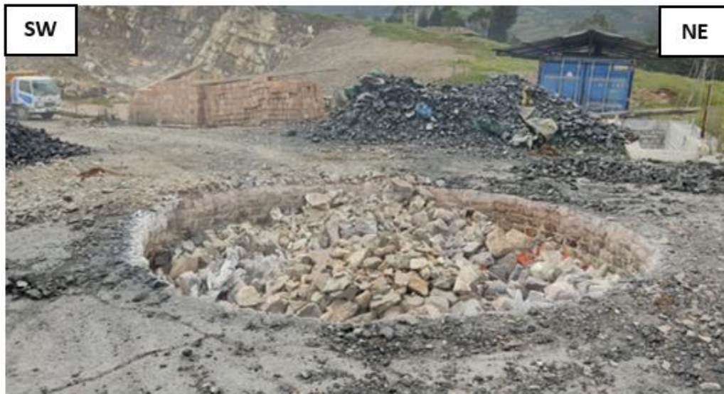
Foto: 4. Calcinación de Piedra Caliza.
