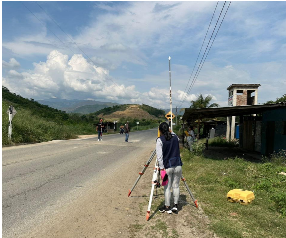
Fotografía N° 3: Toma de puntos del eje central.
