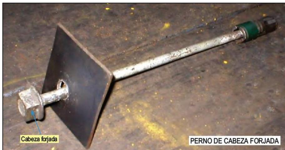
Figura 5. Perno de cabeza forjado.
