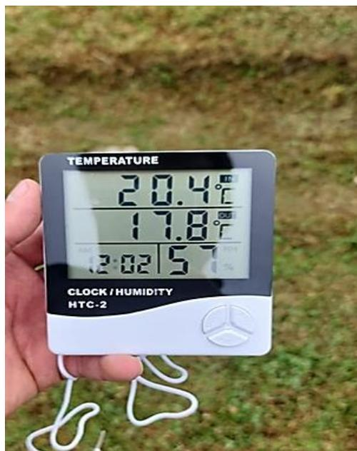
D. Termohigrómetro para la medición de la temperatura.
