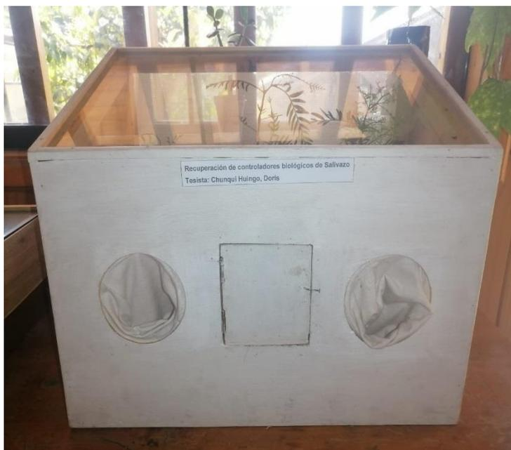
*Nota.* Este dispositivo está compuesto por un espacio cerrado con un marco de madera de forma rectangular, completamente cubierto. Dispone de una puerta para instalar las ramas y de dos orificios para introducir las manos y manipularlas. En la parte superior cuenta con un vidrio que permite la observación de los parasitoides en el interior.
