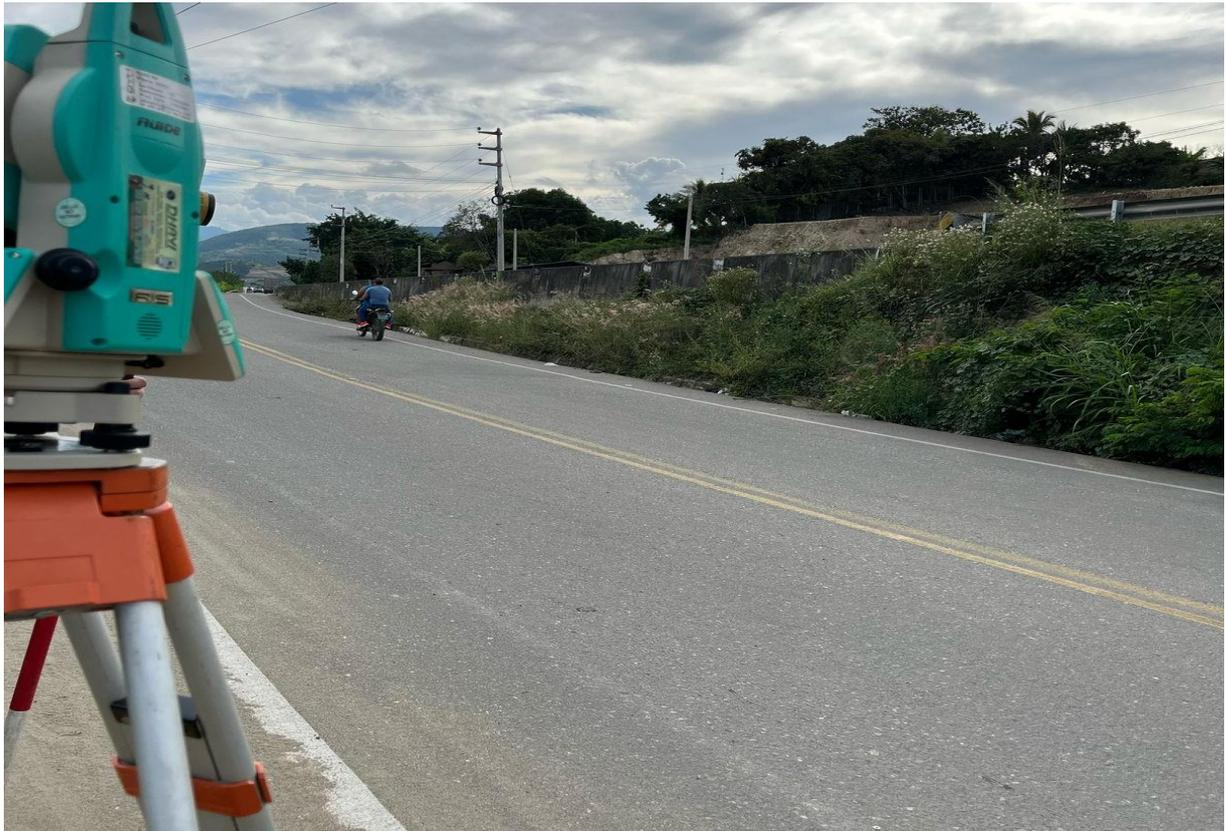
**Figura N°21.** *Toma de puntos en el eje de la vía.*
