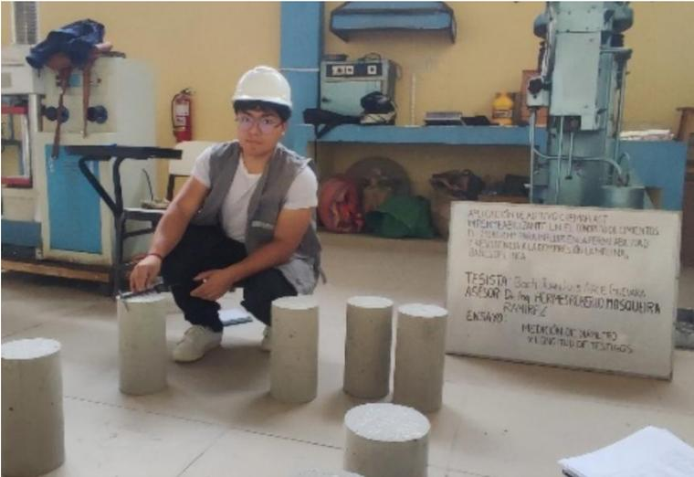
**Figura 21. Ensayo de resistencia a la compresión**
