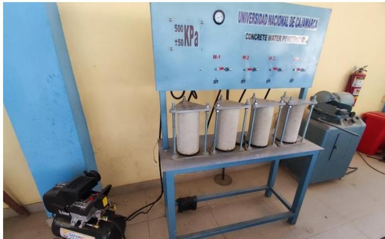
**Figura 23. Penetración del agua al concreto**
