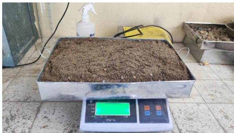
**Figura 17. Peso del agregado grueso para los ensayos de los agregados**
