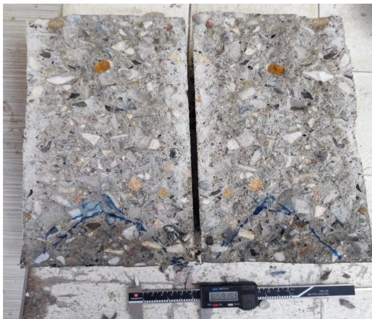
**Figura 24. Ensayo de profundidad de penetración de agua bajo presión en concreto**
