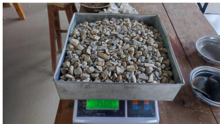
**Figura 18. Ensayo método de prueba estándar para determinar la resistencia a la degradación de agregados grueso por abrasión en la máquina de los ángeles**
