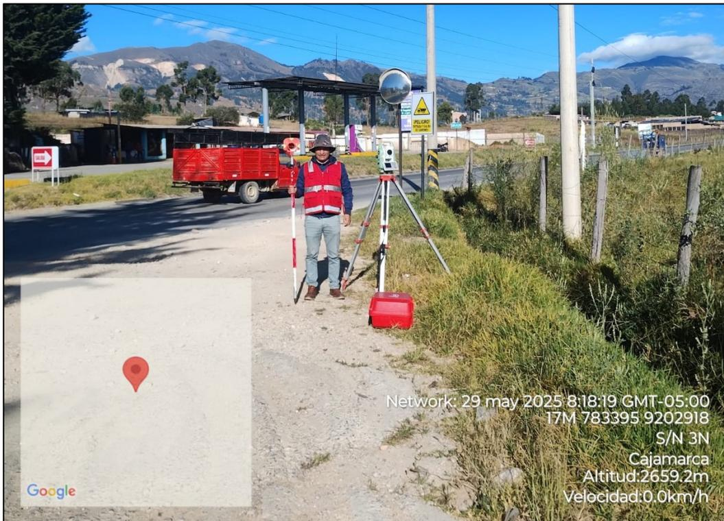
Fotografía 20: Punto Negro N°07, medición de la velocidad de operación.
