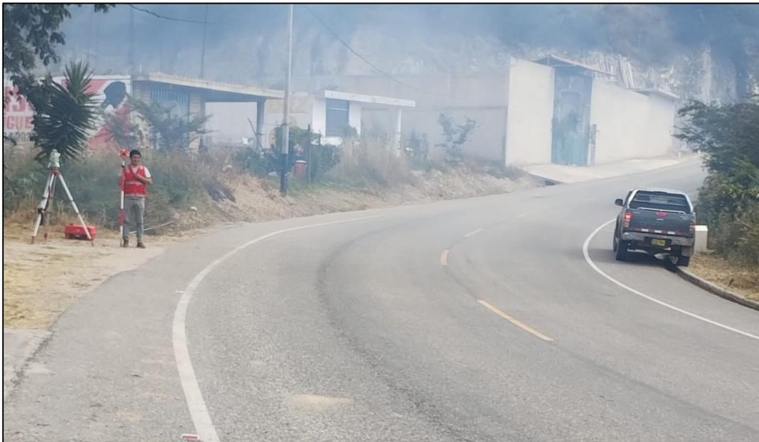
Fotografía 11: Punto Negro N°04, medición de la velocidad de operación.
