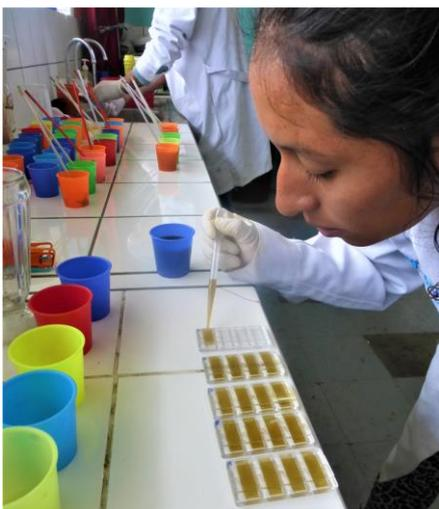
Figura 11. Colocando la muestra en las celdas de la cámara INTA
