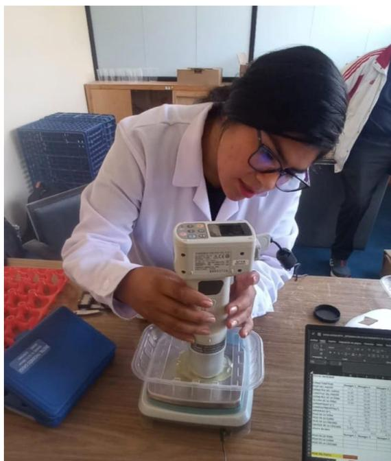
**Figura 8.** Medición del color de la yema con colorímetro Konica Minolta. Este procedimiento permitió obtener los valores de luminosidad ( $L^*$ ), enrojecimiento ( $a^*$ ) y amarillez ( $b^*$ ), parámetros fundamentales para evaluar la calidad visual y nutricional del huevo
