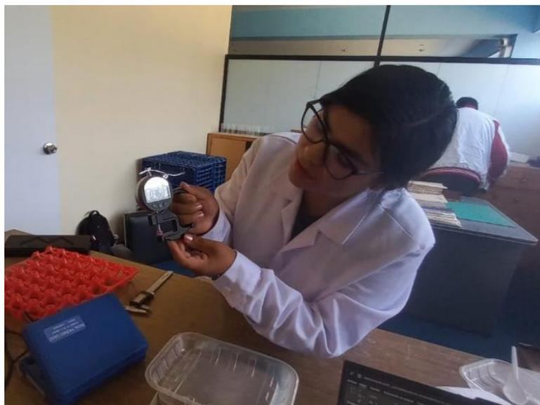
**Figura 10.** Evaluación del grosor de la cáscara utilizando un micrómetro digital de precisión. Este procedimiento se realizó en el Laboratorio de Evaluación de Productos Pecuarios con la finalidad de comparar la resistencia estructural del huevo entre genotipos de gallinas criollas y Novogen Brown
