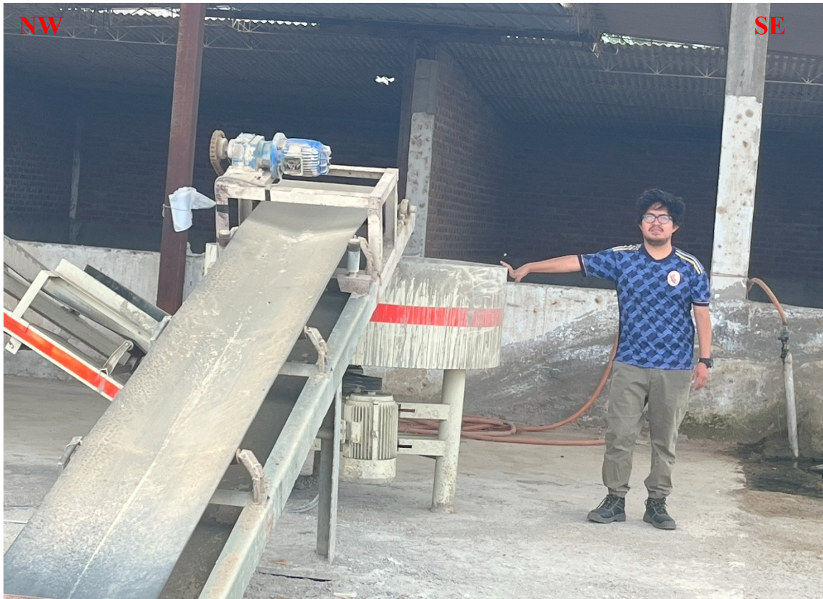
Foto 13: Lavado de arena con el material fino ( <3/8'' )
