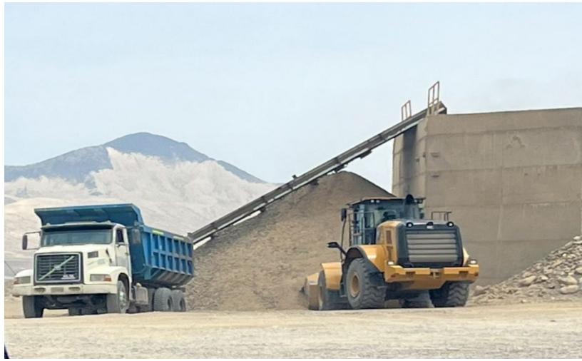
Foto 07: Acarreo de material con volquete Volvo FMX de 15 m 3 y cargador Frontal CAT 938H.
