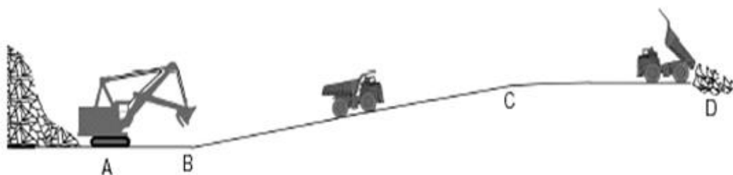
Figura 03: Ciclo de acarreo de un camión en operaciones. Fuente: Juan & Andres, 2016.
