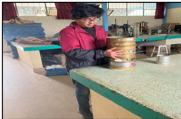
Foto 05: Análisis granulométrico en laboratorio y su caracterización física de los agregados hasta la malla 3"
