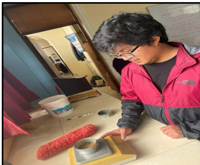
Foto 06: Peso retenido de acuerdo a la malla en el análisis de laboratorio.
