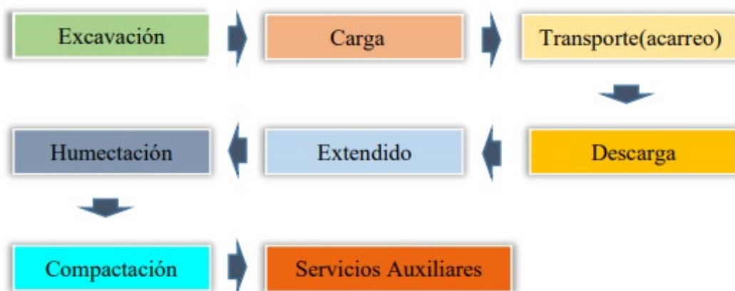
Figura 01: Proceso de Carguío – Acarreo en operaciones. Fuente: Juan & Andres, 2016.
