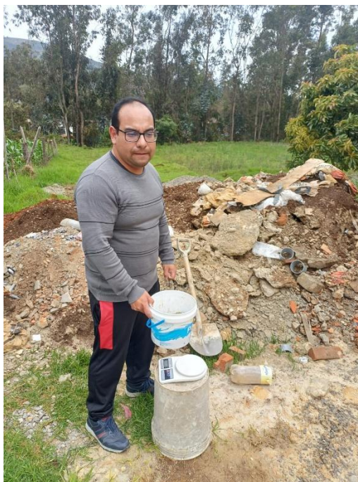
Figura 19. Pesaje 1 Desperdicio Concreto - Vivienda 01
