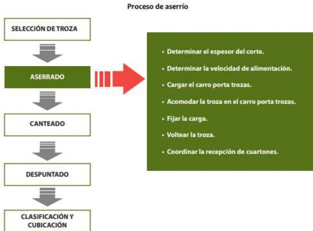
La figura 1 muestra el proceso de aserrío destacando en el aserrado tareas como ajustar espesor, velocidad, cargar y voltrear la troza, y coordinar cuarterones para una transformación eficiente de la madera.
