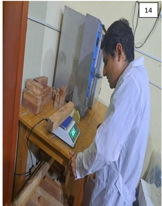
Fotos 13 y 14. Medición y pesado de contenido de humedad de ensayo de probetas mecánicas
