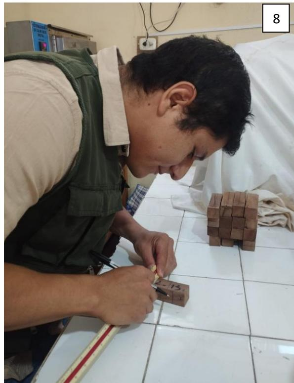
Fotos 7 y 8. Aclimatación y medición de probetas para propiedades físicas
