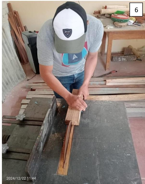
Fotos 5 y 6. Elaboración de probetas en laboratorio para propiedades físicas y mecánicas
