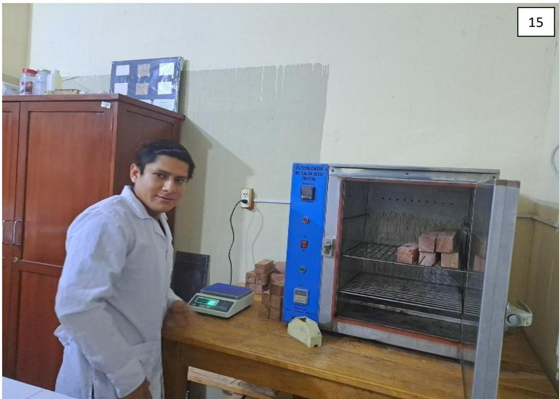
Foto 15. Secado en estufa de probetas de propiedades mecánicas
