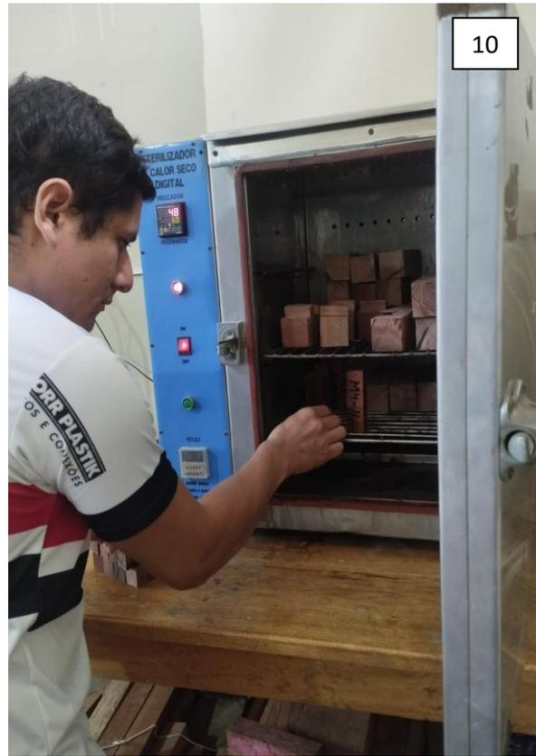
Fotos 9 y 10. Pesado y secado de las probetas de propiedades físicas
