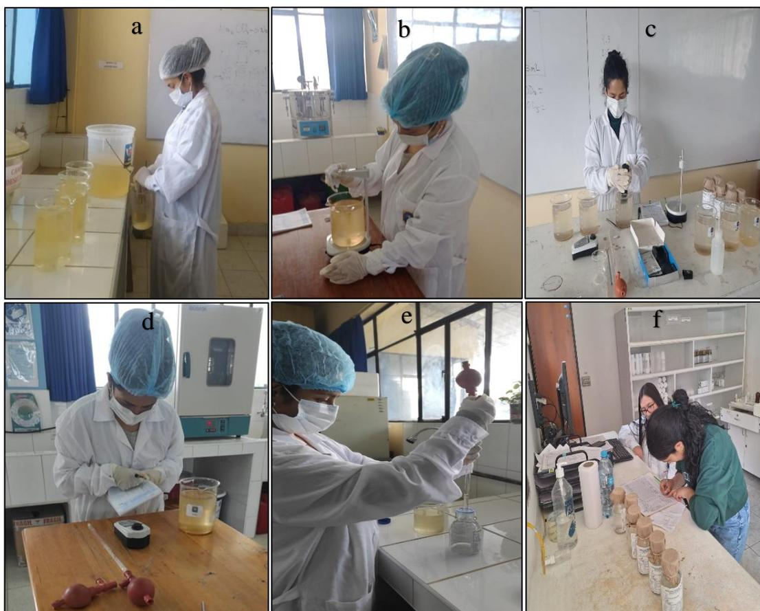
*Nota:* a (Distribución en los 6 beakers), b (Agitación), c (pH, temperatura y conductividad eléctrica), d (Turbidez), e (Muestreo) y f (Entrega al laboratorio).
