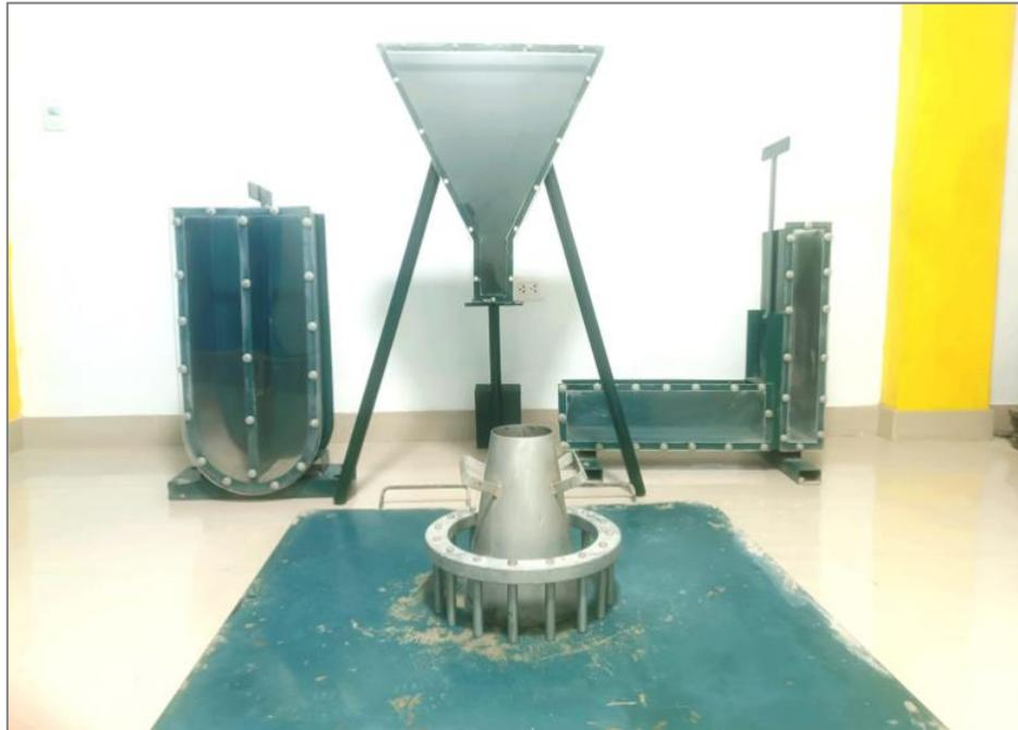
**Figura 28.** Prueba para medir la extensibilidad del concreto fresco.
