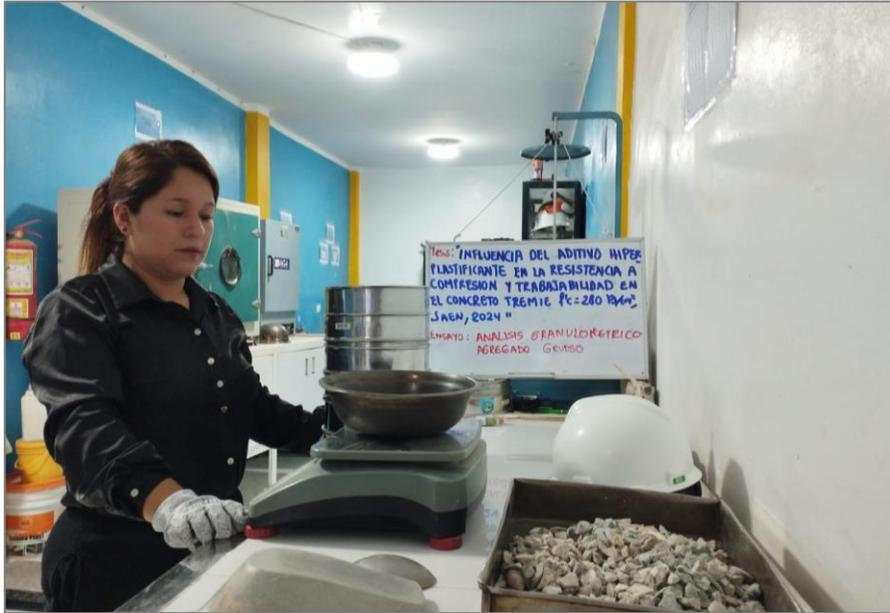
**Figura 22.** *Análisis granulométrico del agregado fino*
