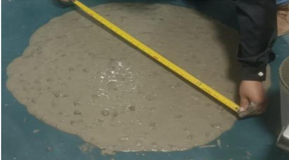
*Nota.* Al realizar los ensayos a la mezcla de concreto con la incorporación del 1.5% de aditivo hiperplastificante se evidencia que se pudo realizar las pruebas de trabajabilidad; Y se evidencia que los resultados no se ajustan en su totalidad a los rangos establecidos por las normativas.
