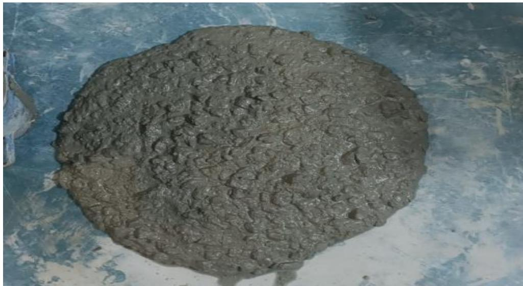
*Nota.* Al realizar los ensayos a la mezcla de concreto con la incorporación del 1% de aditivo hiperplastificante se evidencia que se pudo realizar las pruebas de trabajabilidad; sin embargo, los resultados obtenidos aún no se encuentran dentro de los rangos exigidos por las normativas.
