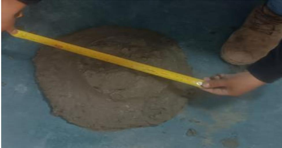
*Nota.* Se muestra el concreto fresco de la muestra patrón, no fue posible realizar los ensayos de capacidad de llenado, capacidad de paso, y también el índice de capacidad visual. Esto debido a que la mezcla de concreto no se logró extender.
