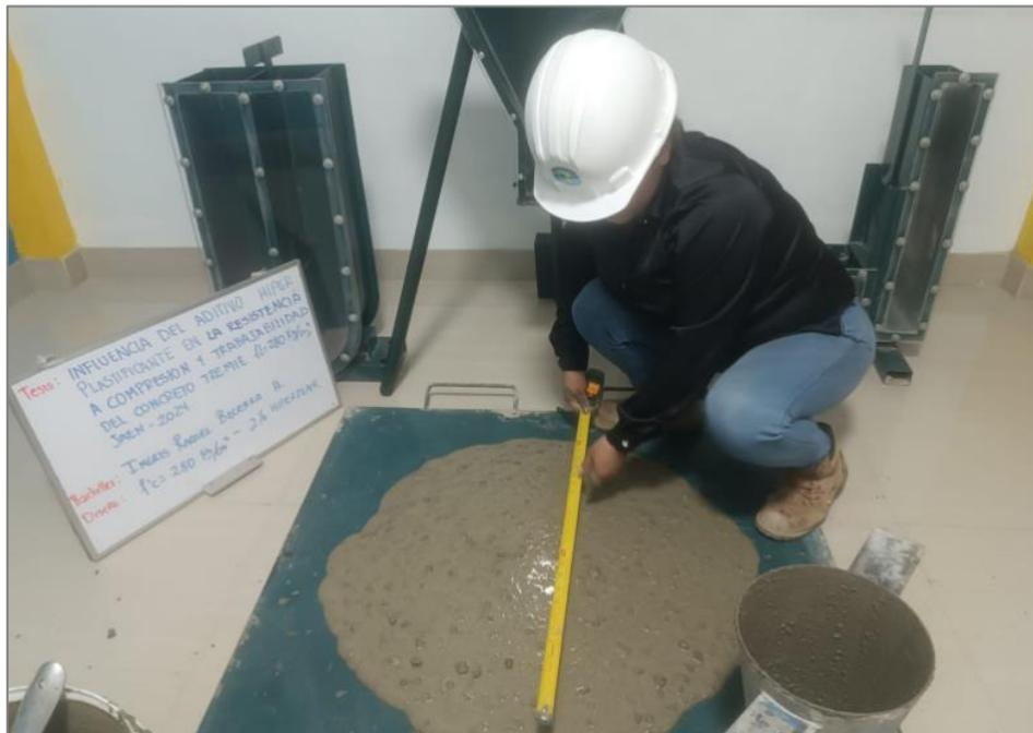
**Figura 29.** Ensayo para medir la capacidad de paso y llenado del concreto fresco.
