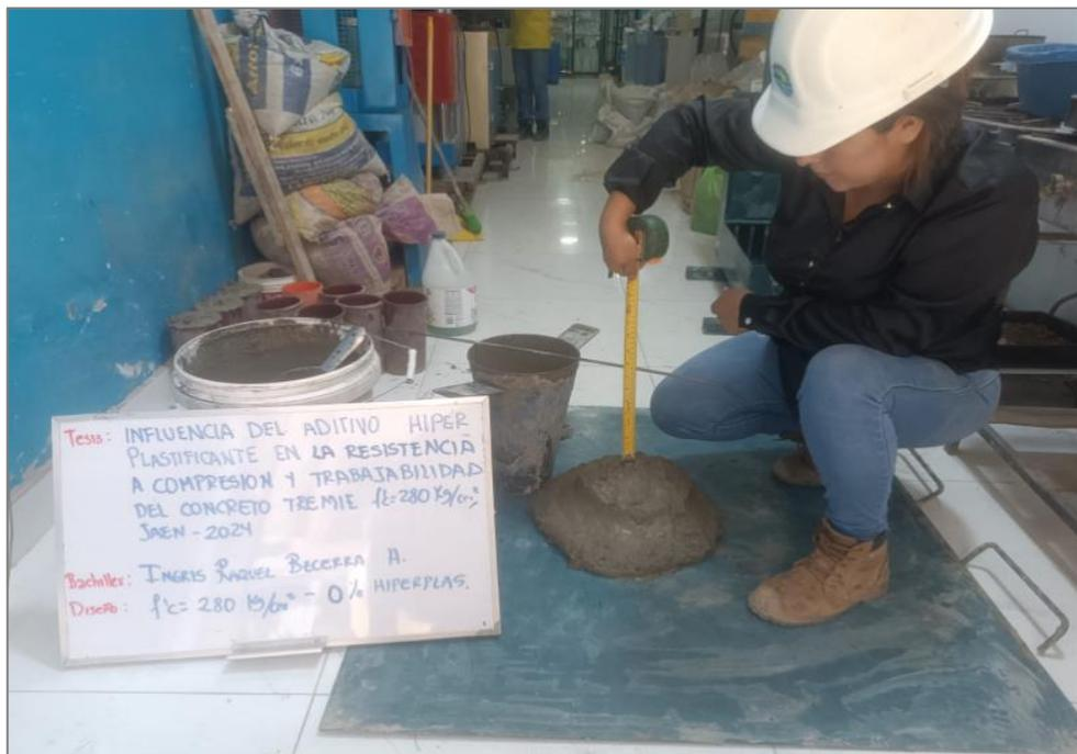
**Figura 31.** *Elaboración de testigos de concreto.*
