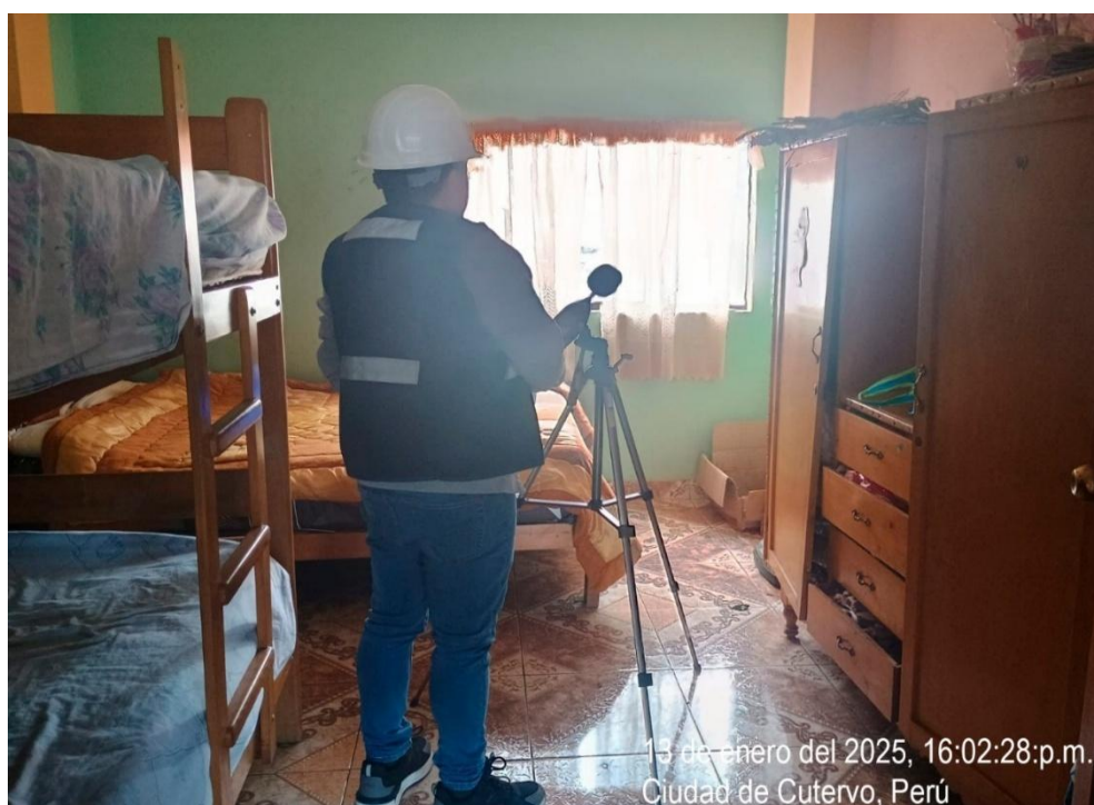
Figura 26. Medición de aislamiento acústico en edificación de la ciudad de Cutervo ubicada en el Jr. Progreso Cdra. 6.
