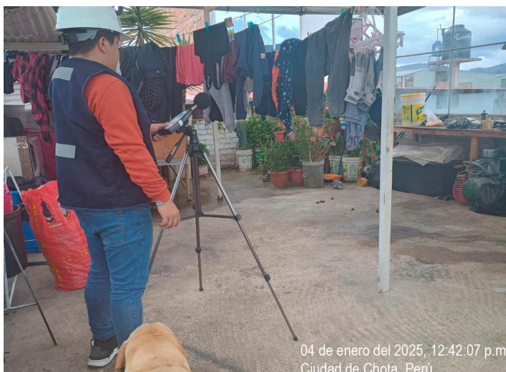
Figura 20. Medición de aislamiento acústico en edificación de la ciudad de Chota ubicada en la Av. Todos los Santos Cdra. 7.
