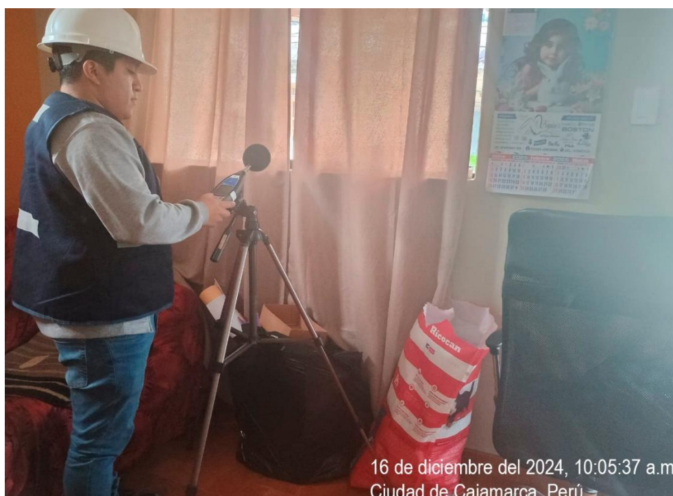
Figura 18. Medición de aislamiento acústico en edificación de la ciudad de Cajamarca ubicada en el Jr. Guillermo Urrelo Cdra. 12.
