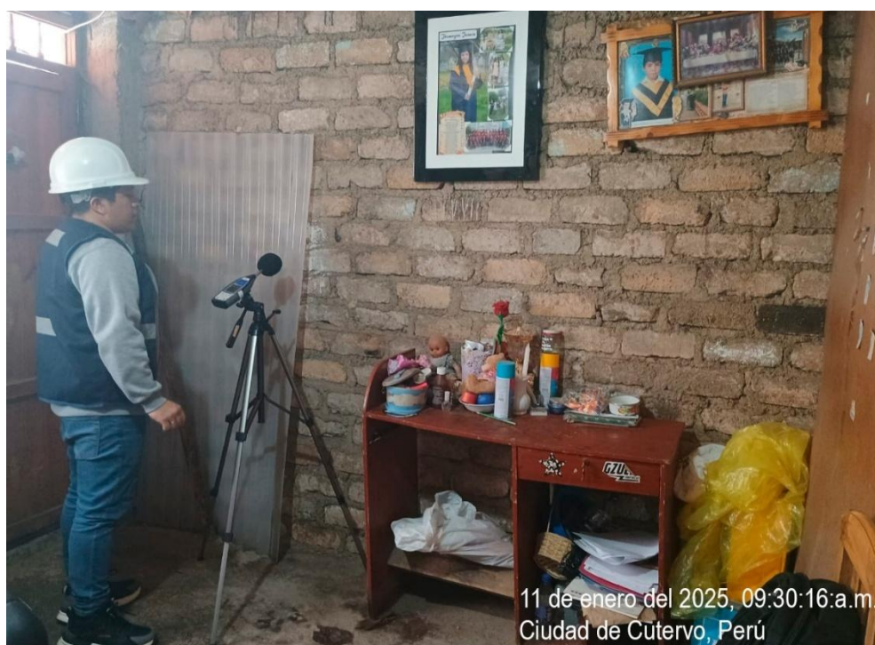
Figura 24. Medición de aislamiento acústico en edificación de la ciudad de Cutervo ubicada en el Jr. Lima Cdra. 5.
