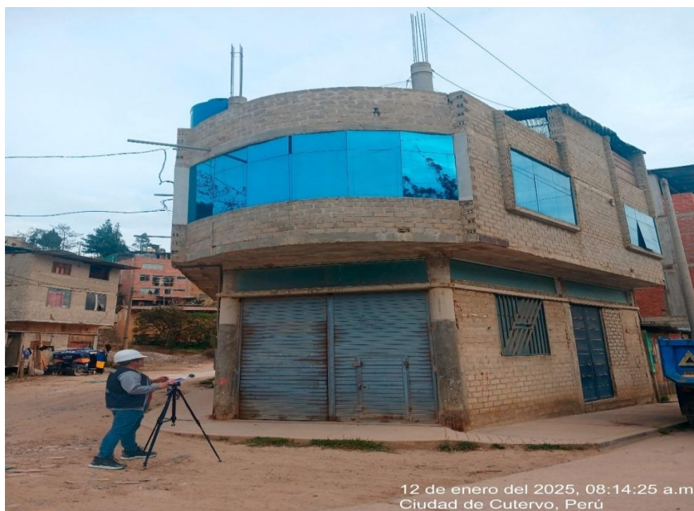
Figura 25. Medición de aislamiento acústico en edificación de la ciudad de Cutervo ubicada en calle Unión Cdra. 1.
