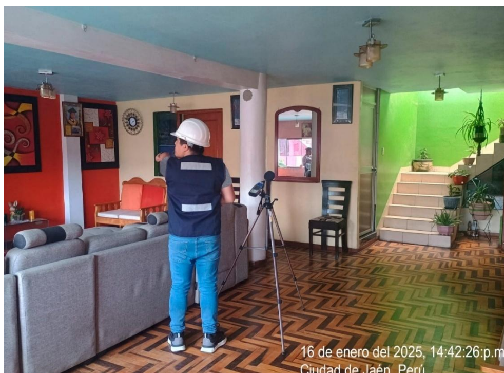
Figura 30. Medición de aislamiento acústico en edificación de la ciudad de Jaén ubicada en el Jr. San Martín Cdra. 19.
