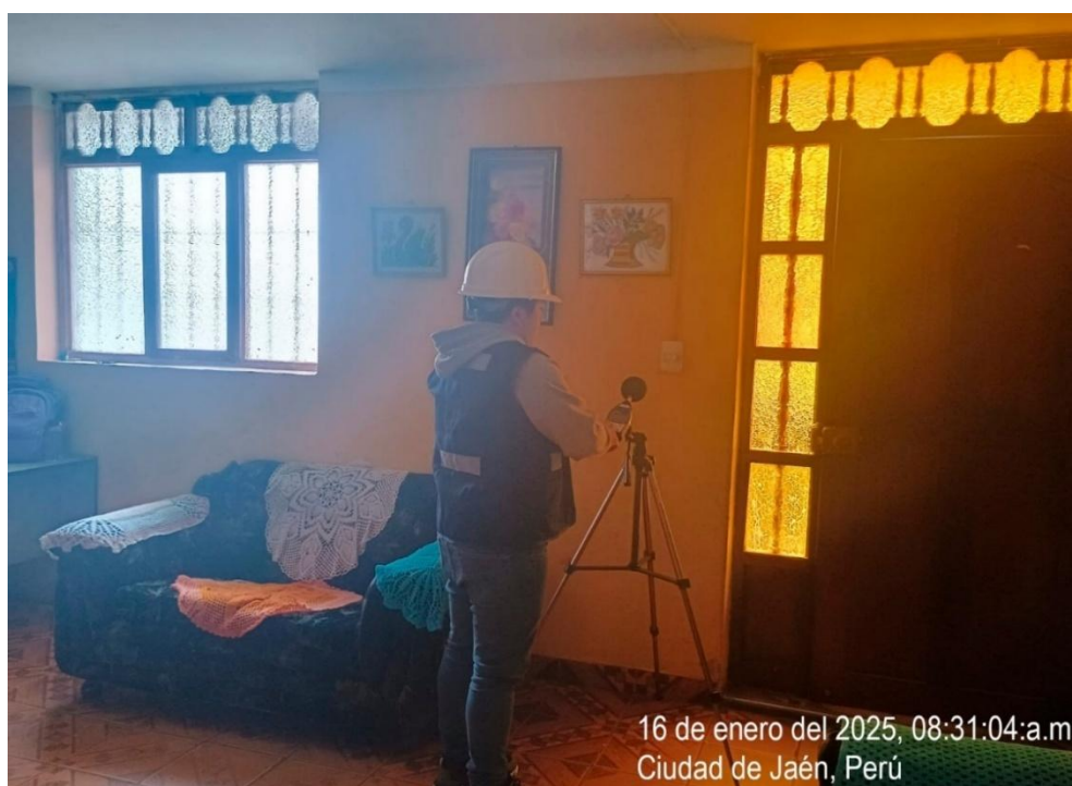
Figura 28. Medición de aislamiento acústico en edificación de la ciudad de Jaén ubicada en la calle Los Sauces Cdra. 1.
