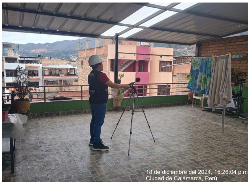
Figura 16. Medición de aislamiento acústico en edificación de la ciudad de Cajamarca ubicada en la calle Jorge Pozo Manrique Cdra. 1.
