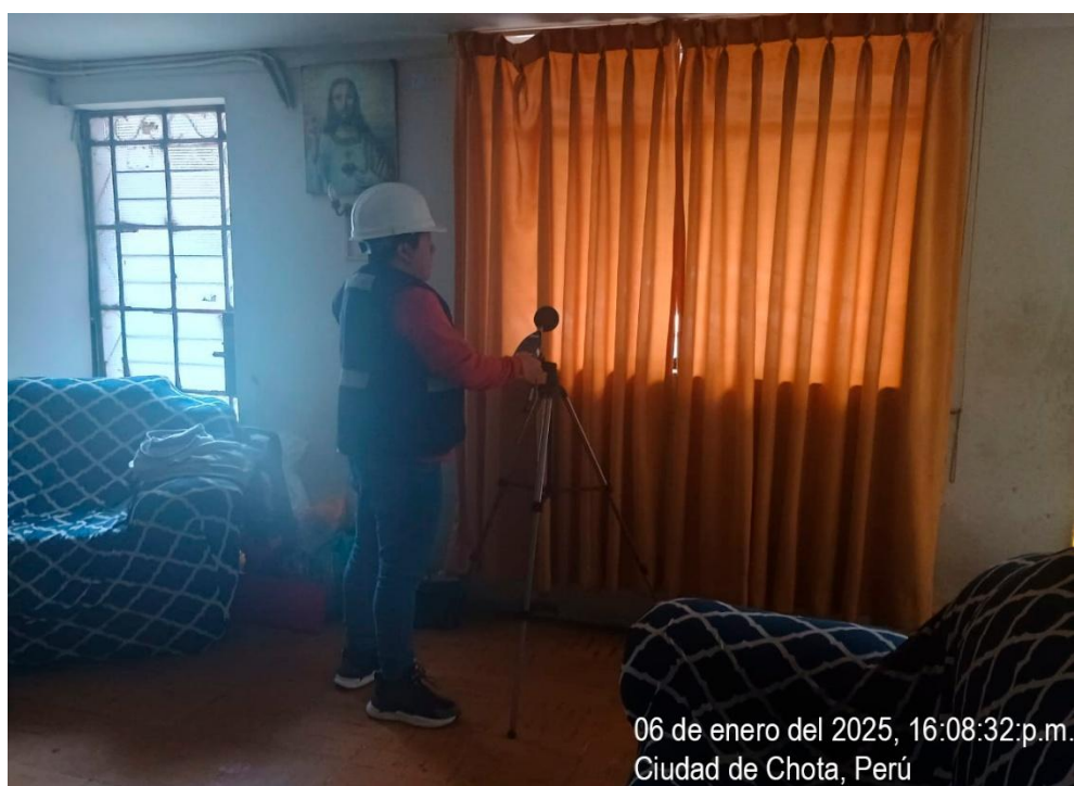
Figura 22. Medición de aislamiento acústico en edificación de la ciudad de Chota ubicada en la calle Santa. Rosa Cdra. 4.
