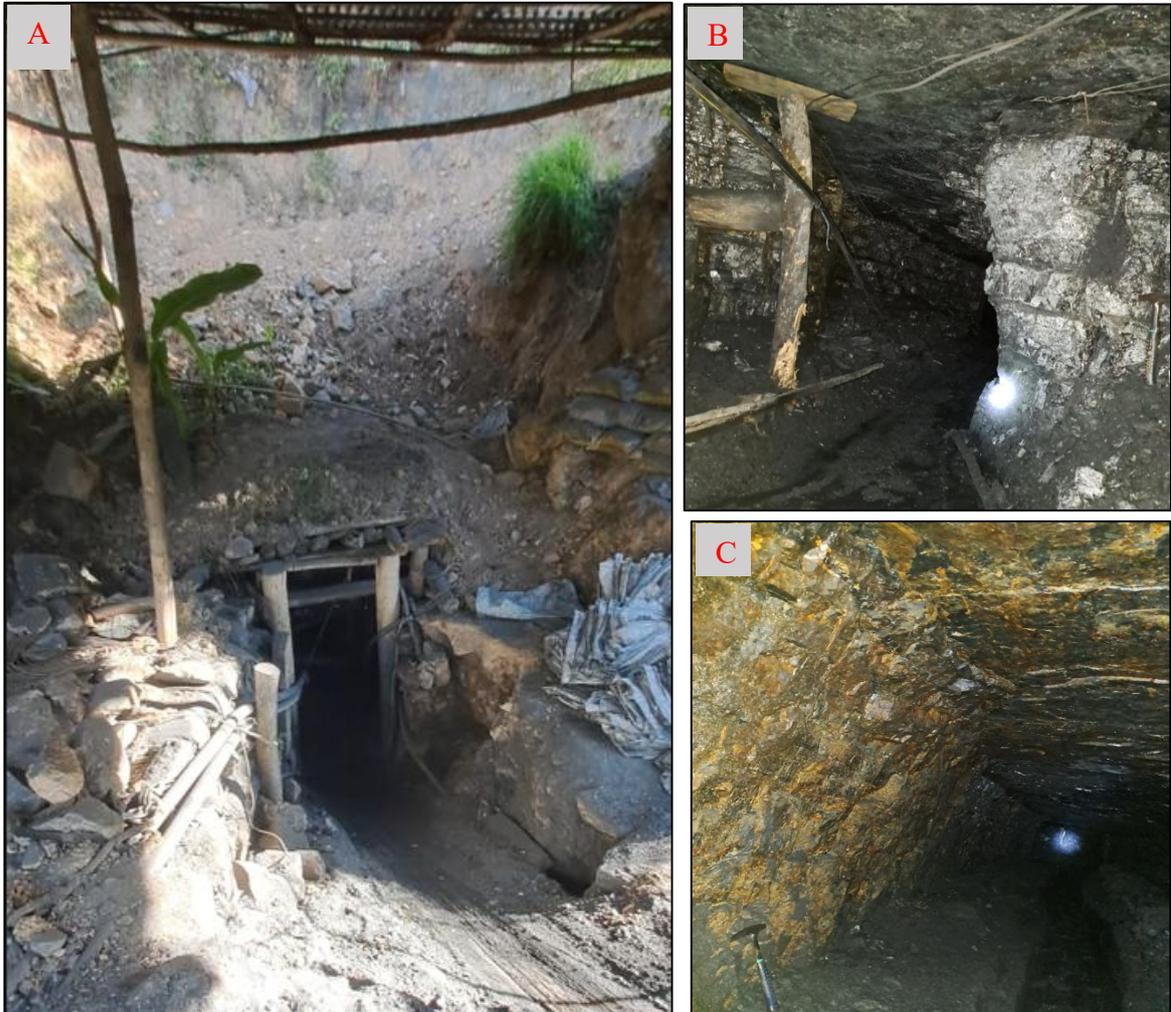
Foto 24: A: Bocamina El Zorro. B: Se realizó el reconocimiento de la labor, hastial izquierdo con puntal de madera. C: Caracterización petromineralógica en interior mina, entrando al hastial izquierdo (E: 781603, N: 9272149, C: 2069msnm).
