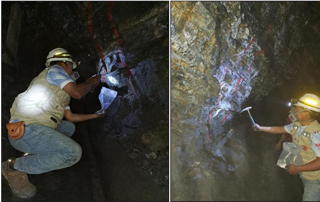
Foto 25: Observación, descripción y muestreo por canal de los mantos de carbón en interior de la mina El Zorro (E: 781603, N: 9272149, C: 2069msnm).
