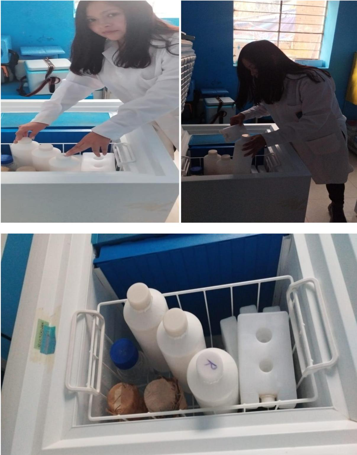
**Foto 6.** Agregado de los reactivos correspondientes a cada muestra y refrigeración para su conservación y ser trasladados al Laboratorio Regional del Agua.
