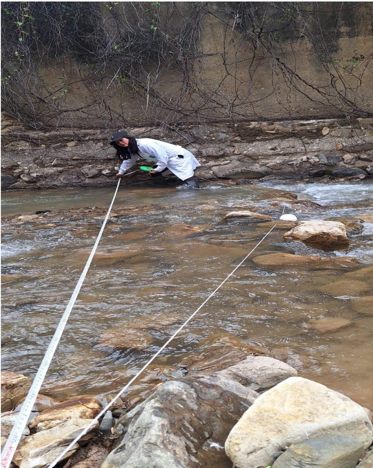
**Foto 5.** Medición del ancho, largo y profundidad para poder determinar el caudal del río
