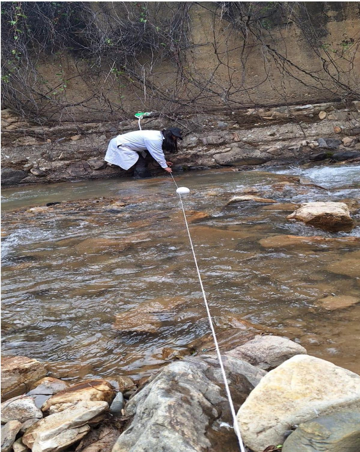
**Foto 4.** Adecuación de cordel para luego las profundidades en diferentes puntos del río.
