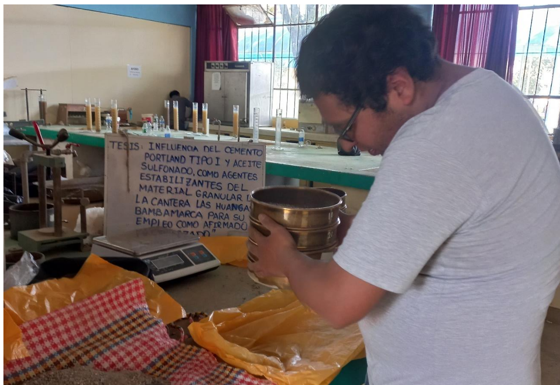
Figura 12: Ensayo de análisis granulométrico de la muestra sin aditivo.
