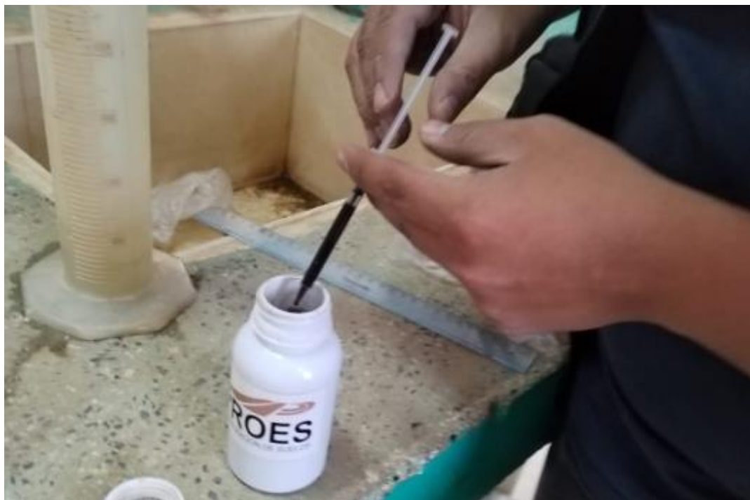
Figura 16: Medición de cantidad de aditivo proes para el ensayo de proctor modificado.
