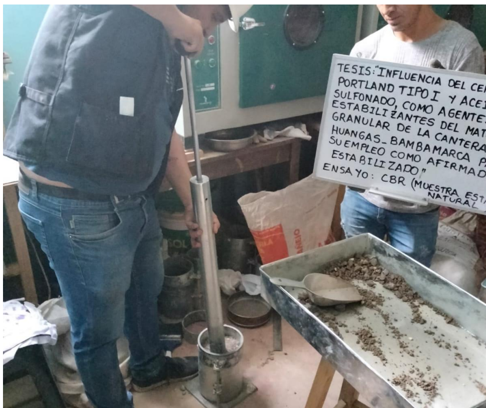
Figura 17: Compactación por capas del ensayo de CBR.
