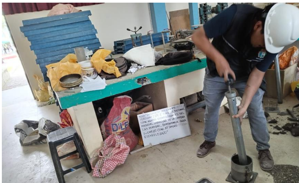
Figura 15: Ensayo de Proctor modificado de la muestra sin aditivo.
