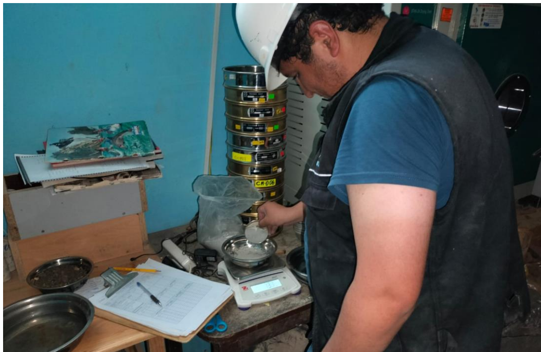
Figura 18: Peso del cemento para el ensayo de CBR de la muestra con aditivos.
