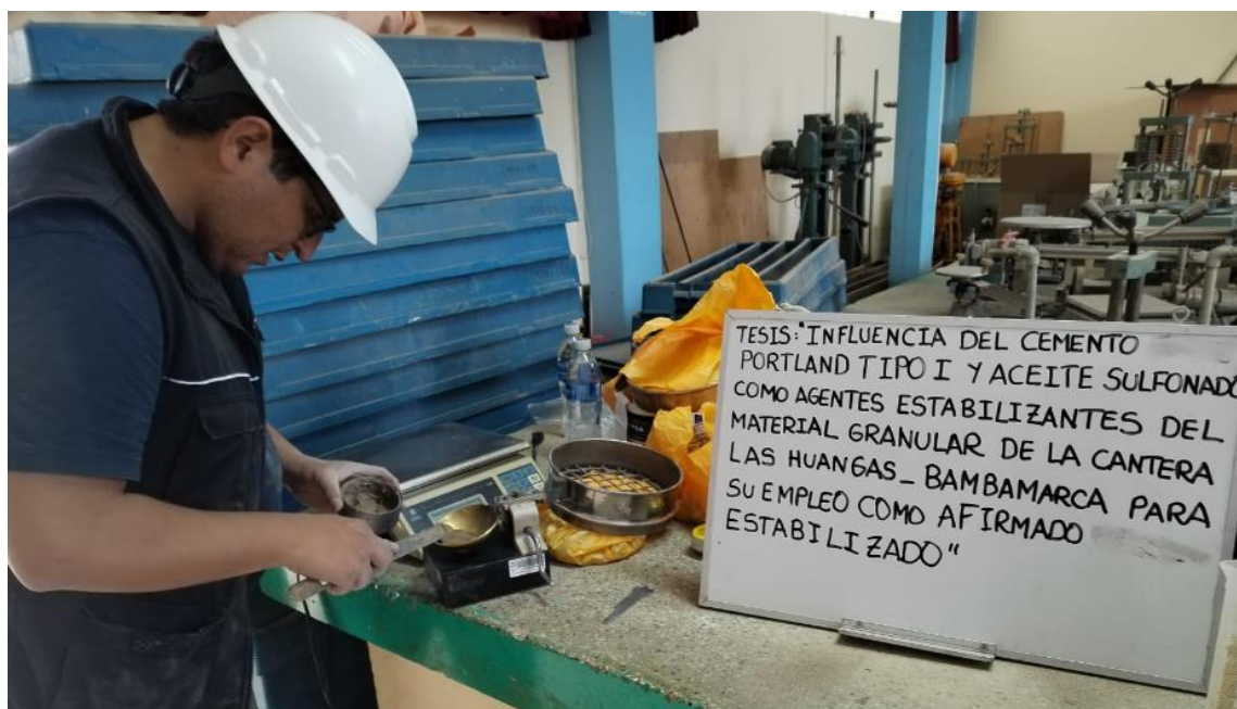
Figura 13: Ensayo de límite líquido de la muestra sin aditivo.
