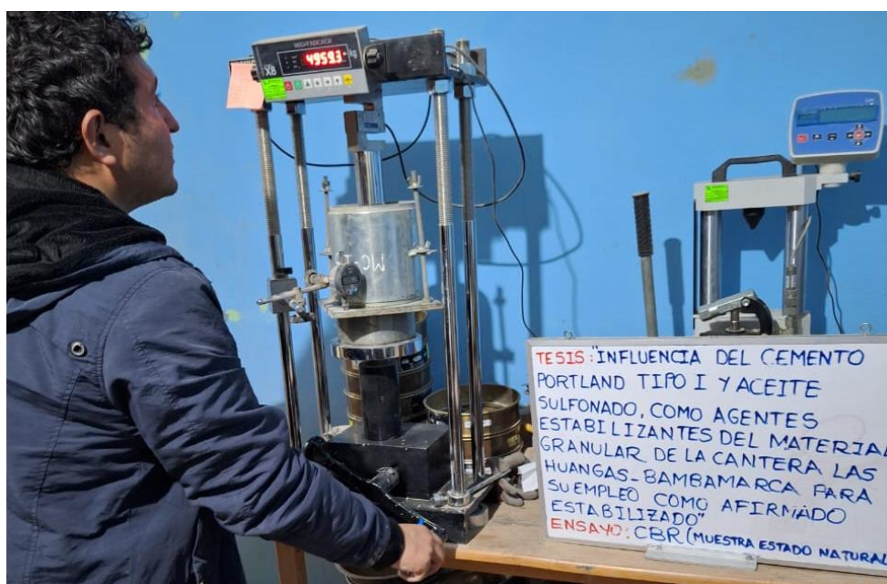
Figura 21: Carga penetración del ensayo de CBR de la muestra sin aditivo.
