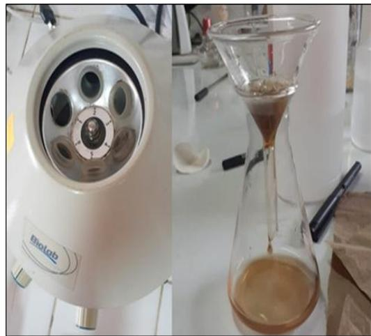
Foto 28. Centrifugación y colocación de muestra de suelo en papel filtro
