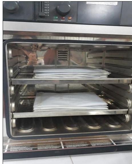
Foto 30. Secado de muestras para biomasa en estufa a 75 °C
