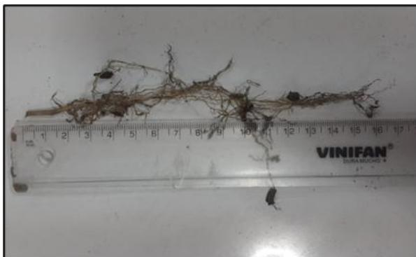
*Nota:* en la figura 4, demuestra la medición de la longitud de la raíz de la especie después de 4 meses de permanencia en el vivero.
