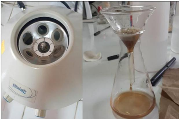
*Nota:* en la figura 8 la colocación de las muestras depositado en los tubos de centrifugación y la decantación haciendo uso del papel filtro y embudo.
