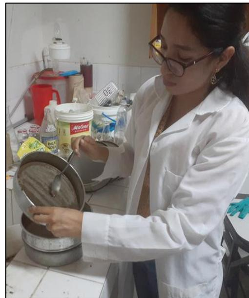
Foto 26. filtro a través de un juego tamices de 4000, 500, 250, 125 y 63  $\mu$ m
