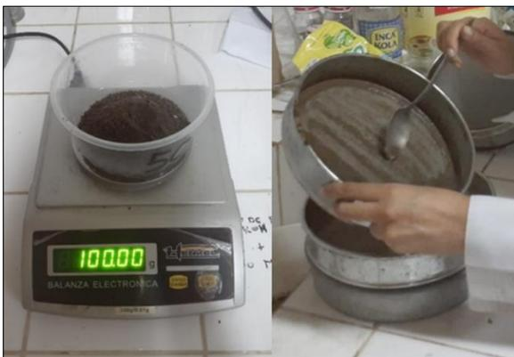
*Nota:* en la figura 7 se muestra el peso de suelo 100 g y el último proceso de tamizado correspondiente a 63  $\mu\text{m}$ .
