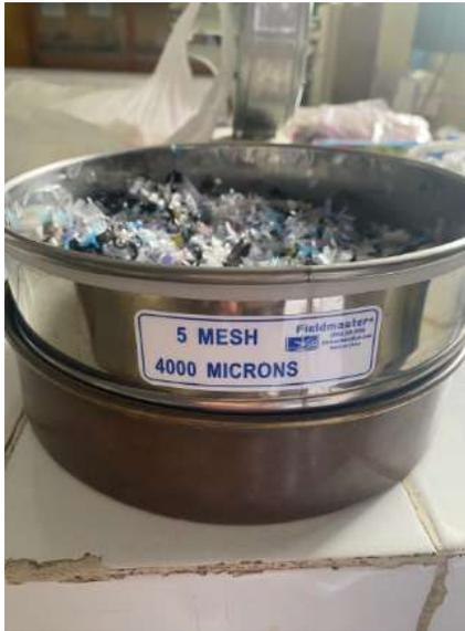
*Nota.* Se muestra el tamizado de microplásticos para obtener partículas menores a 5mm.
