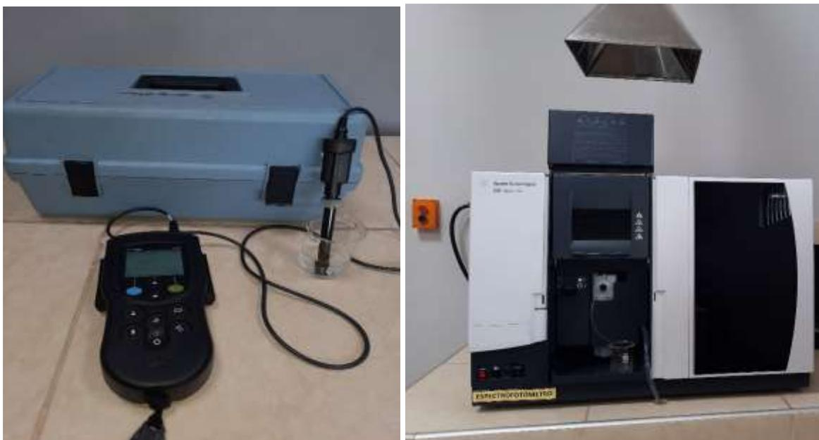
Foto 1: Izquierda: multiparámetro portátil Hach; derecha: Espectrofotómetro Agilent Technologies 240-F
